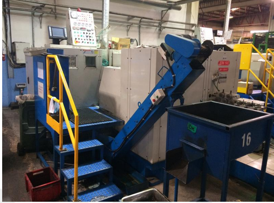
Şekil 4.28. Prototip Üretimi Yapılan Soğuk Dövme Presi
