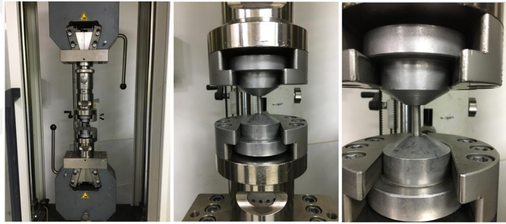
Şekil 4.45. Çekme Test Cihazı Civata Çekme Düzeneği
