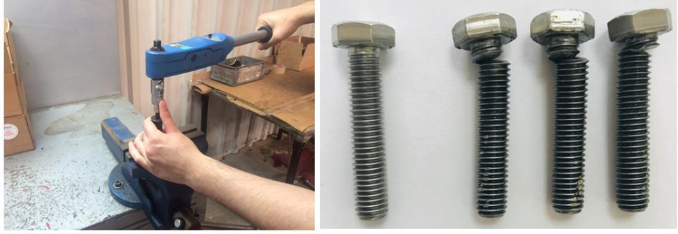
Şekil 4.48. Kırılma Torku Testi ve Test Edilen Numuneler
