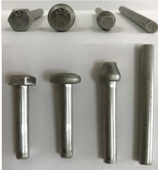
Şekil 4.31. Gerçek İstasyon Numuneleri
