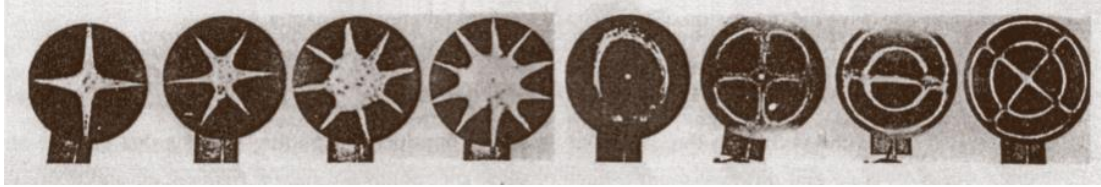
Şekil 2.1. Dairesel bir plaka üzerinde Chladni desenleri [7]
