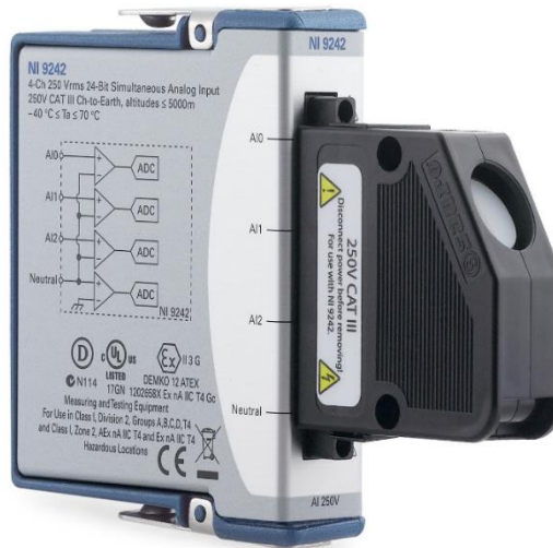
Şekil 3.20. NI-9242 C Serisi gerilim giriş modülü
