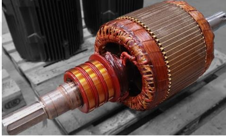
Şekil 2.4. Bilezikli (sargılı) rotor
