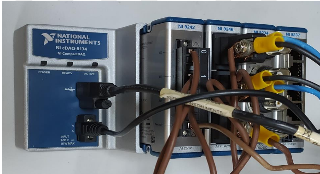
Şekil 3.8. NI ölçüm modülleri ve NI cDAQ 9174 şasesi
