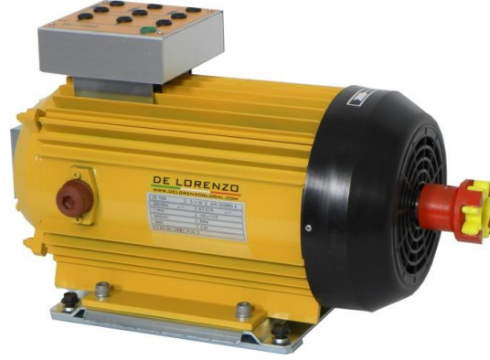
Şekil 3.9. Deneyde kullanılan asenkron makine
