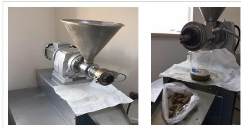
Şekil 3.2. Soğuk pres yöntemiyle susam yağı eldesi
