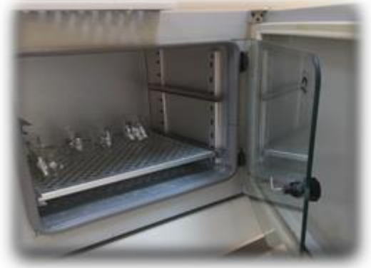
Şekil 3.11. Soğuk pres susam yağlarının bekletildiği inkibatör
