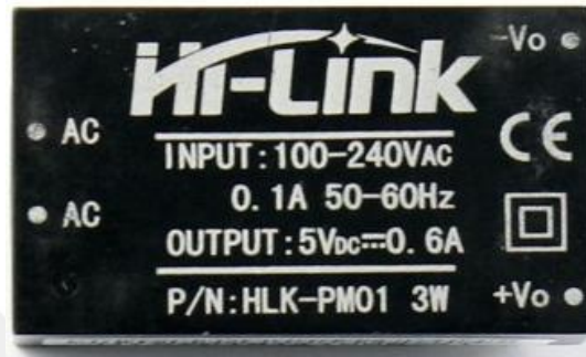
Şekil 3.21. HLK-PM01 güç kaynağı modülü
