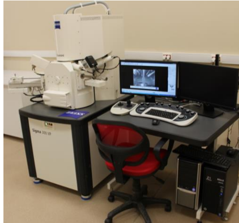
Şekil 3.18. Taramalı elektron mikroskobu, Carl Zeiss 300VP [29]
