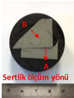
Şekil 4.5. Tam dalgalı tam değişkenli hızlandırılmış yorulma testi sonrası çatallı flanşın hasar görmemiş kısmından alınan numune, A: Spotface Bölgesi, B: Dış Çap
