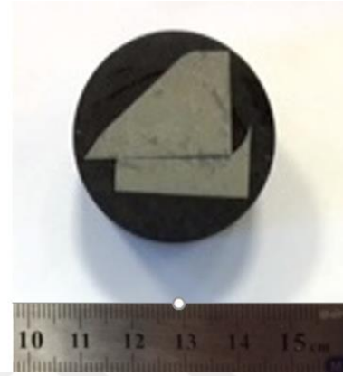
Şekil 3.16. Yorulma testi sonrası kırılan çatallı flanştan alınan numune
