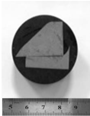
Şekil 4.10. Tam dalgalı tam değişkenli yorulma testi sonrasında alınan çatallı flanş numunesi
