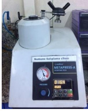
Şekil 3.9. Sıcak kalıplama cihazı, Metkon Metapress-A
