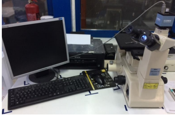
Şekil 3.17. Nikon MA100 metal mikroskobu ve Clemex görüntüleme yazımı
