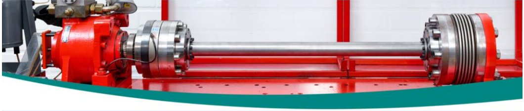
Şekil 2.10. Statik torsiyon test cihazı [13]
