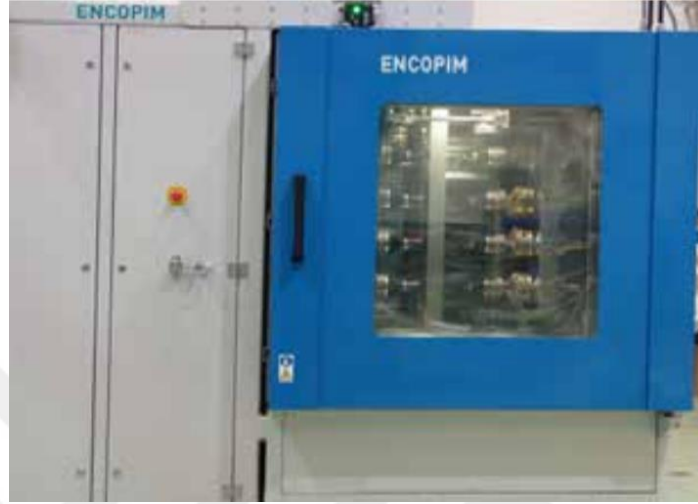
Şekil 2.14. Klimatik kabin test cihazı [14]
