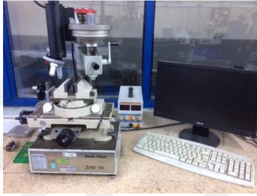
Şekil 3.12. Vickers sertlik cihazı, Zwick ZHV10
