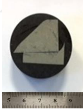
Şekil 4.15. Tam dalgalı tam değişkenli yorulma testi sonrası çatallı flanş birim parçası numunesi
