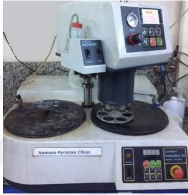
Şekil 3.10. Zımparalama ve parlatma cihazı, Metkon Forcipol-2V
