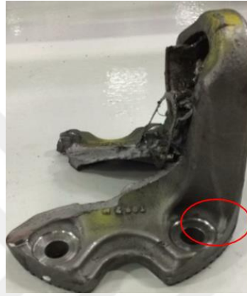
Şekil 3.16. Yorulma testi sonrası kırılan çatallı flanştan alınan numune
