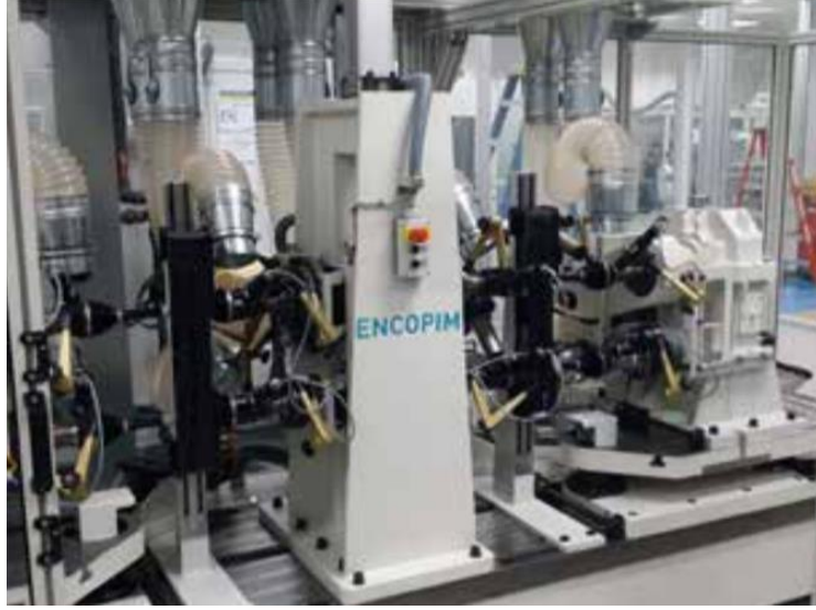
Şekil 2.12. Dinamik dayanıklılık test cihazı [14]
