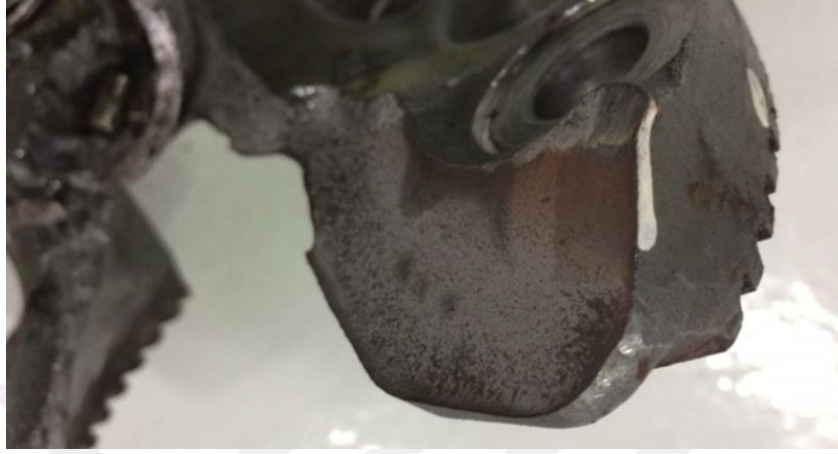
Şekil 3.19. Yorulma testi sonrası kırılan çatalı flanşın incelenen kırık yüzeyi.
