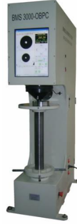
Şekil 3.13. Brinell sertlik cihazı, BULUT BMS3000-OBPC
