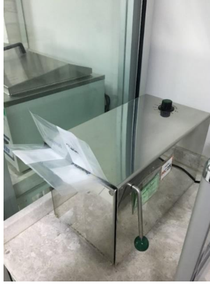
Şekil 3.3. Örneklerin Stomacherde Homojenizasyonu
