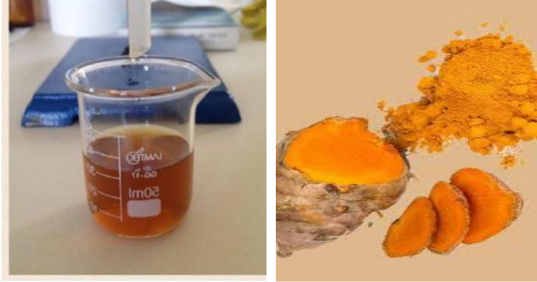
Şekil 3.2. Curcuma longa L. rizomları ve %70'lik metanol-su ekstraksiyonu sonrası elde edilen ekstrakt
