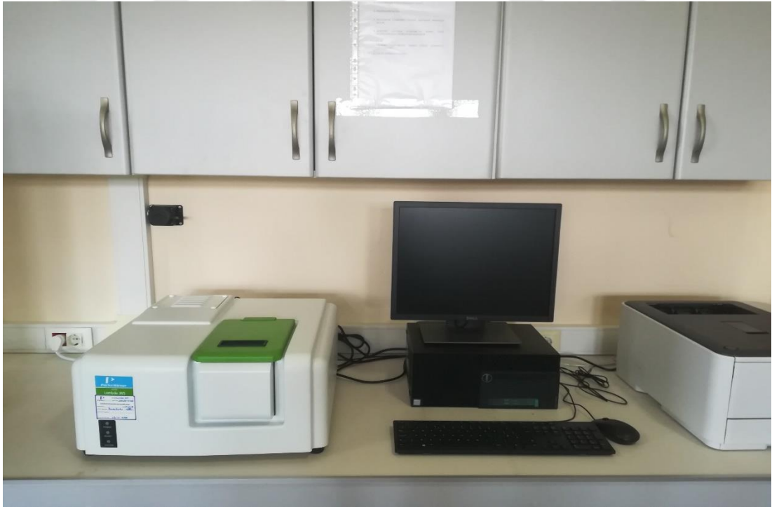
Şekil 3.1. Toplam antioksidan, fenolik ve radikal giderme kapasitelerinin analizinde kullanılan Uv-vis Spektrofotometre
