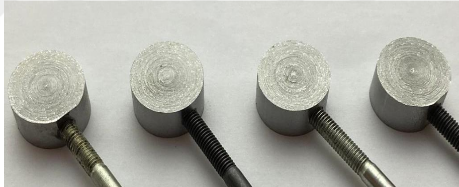
Şekil 3.7. Vida ile aparatlanan numuneler
