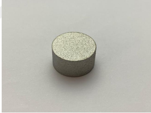
Şekil 3.8. Yüzeyi kumlanmış numune örneği
