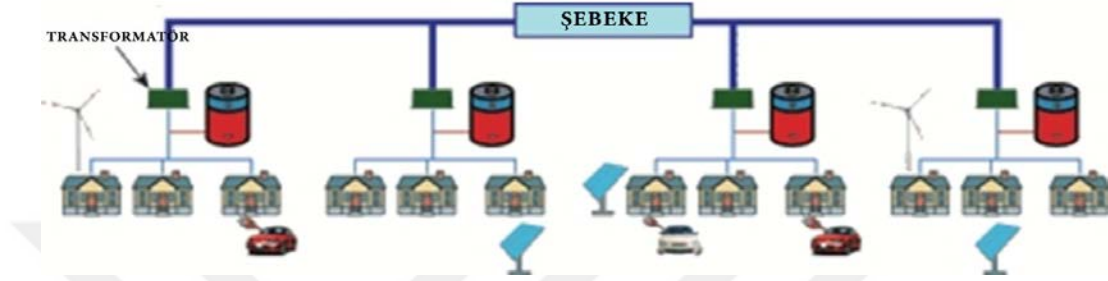
Şekil 1.2. Dağıtım Ağında Merkezi Batarya Sistemi
