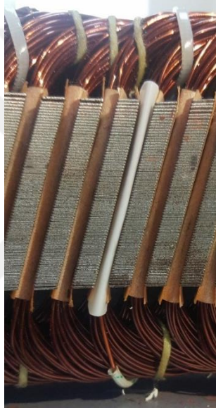
Şekil 4. 19 Bir iletkendeki ölçümler için yerleştirilen ek iletken
