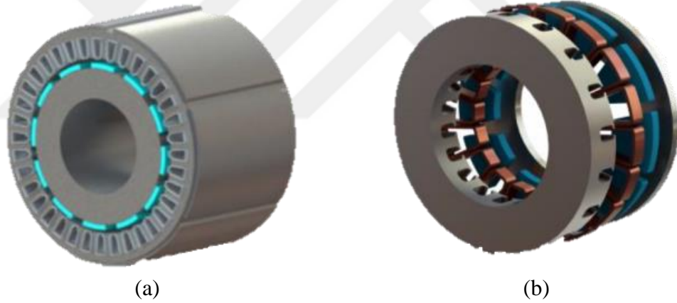
Şekil 2.13. (a) Radyal akılı makina (b) Aksel akılı makina [27]
