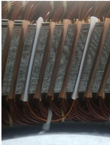
Şekil 4. 20 Bir sarımdaki ölçümler için yerleştirilen ek iletken
