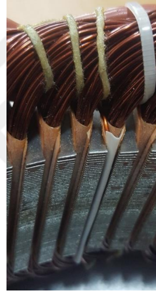
Şekil 4. 19 Bir iletkendeki ölçümler için yerleştirilen ek iletken
