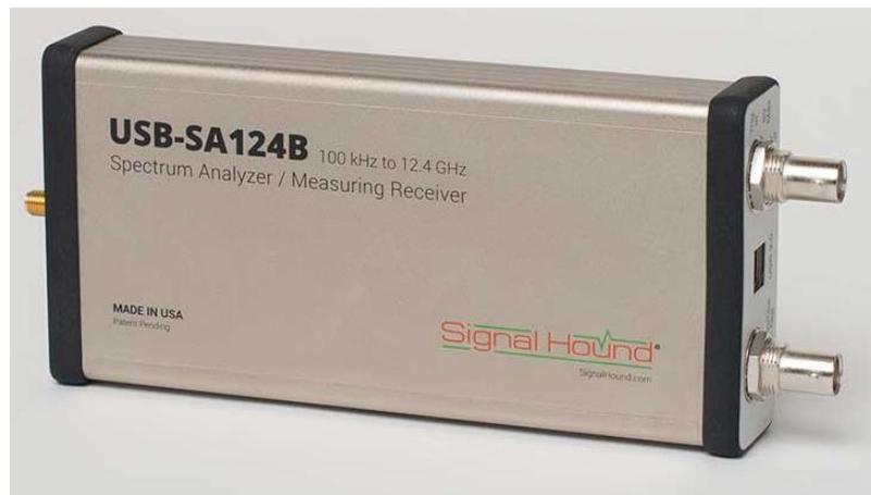
Şekil 4.8. Signal Hound USB-SA124B spektrum analizörü
