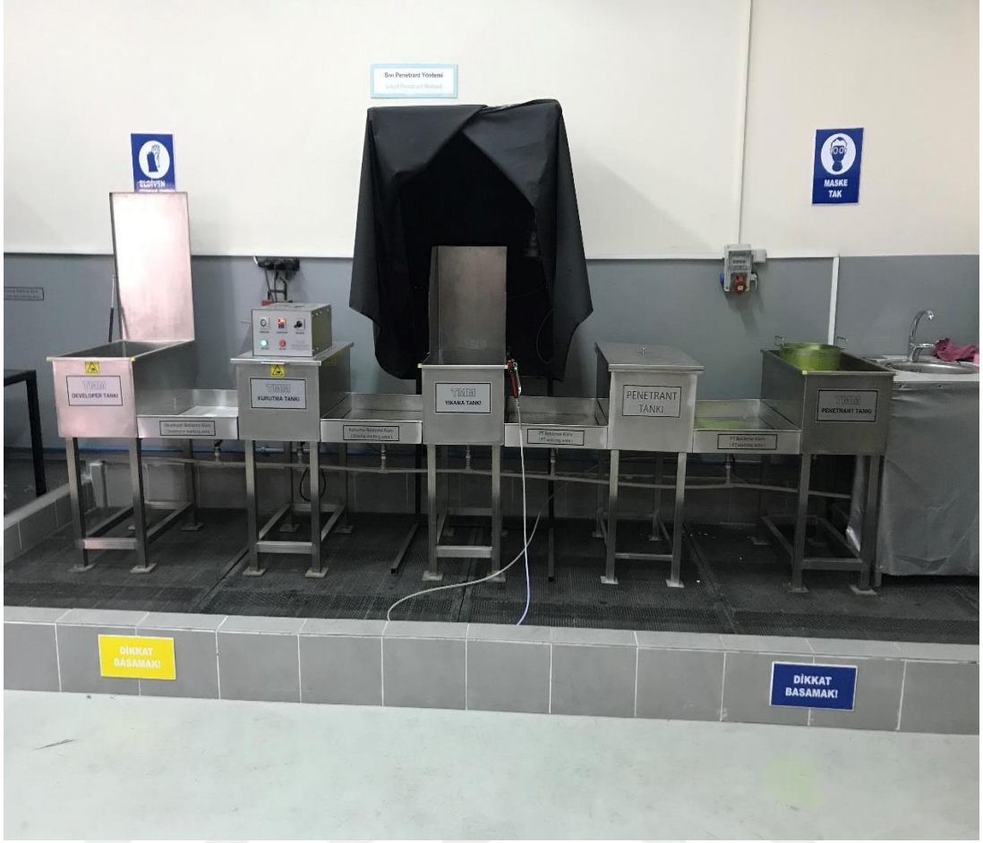
Şekil 7.15. Penetran sıvı operasyon kademeleri
