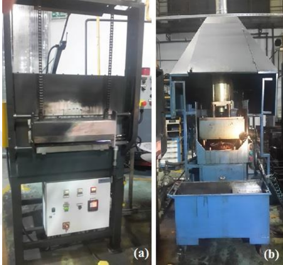
Şekil 7.2. (a) Isıtım fırını (b) Isıtılan parçanın şekillendirilip yağda su verme işlemi yapıldığı pnömatik pres (Dönmez Debriyaj)
