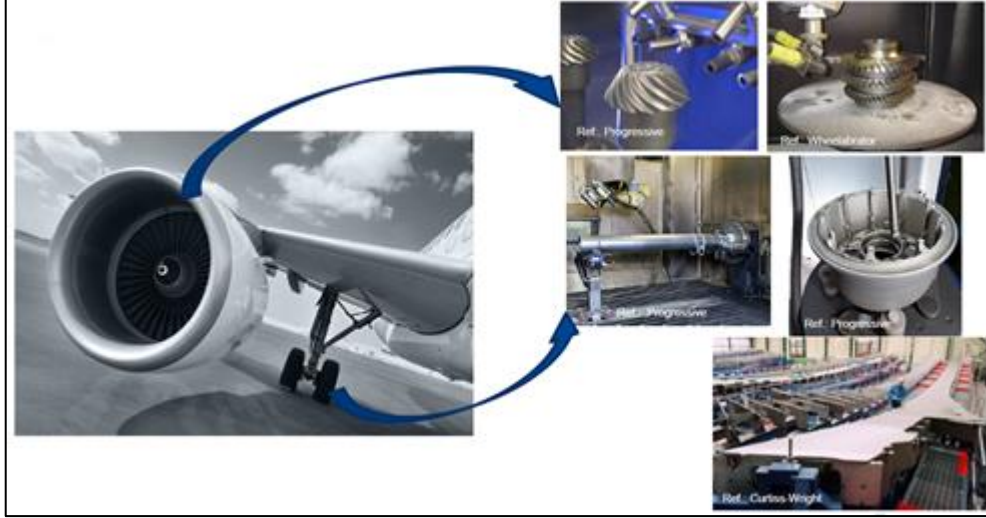
Şekil 4.12. Havacılık endüstrisinde bilyalı dövme işlemine ait bir uygulama (Uçak kanadı) [52].
