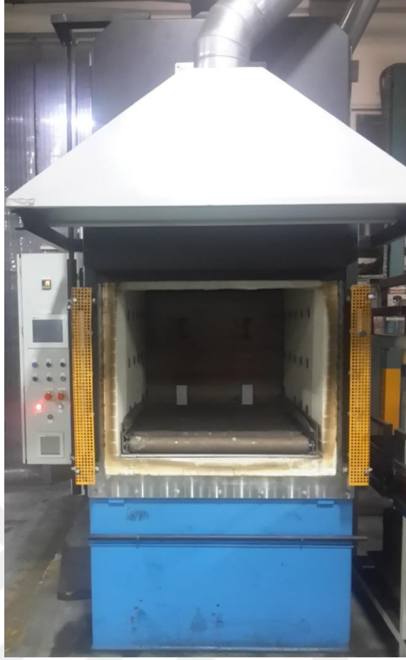
Şekil 7.4: Temperleme Fırını (Dönmez Debriyaj)
