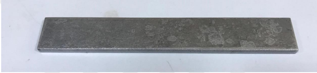
Şekil 7.13. Bilyalı dövme sonrası test numunesi
