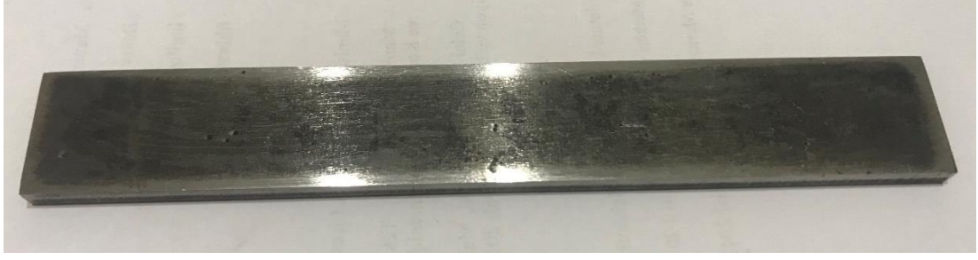
Şekil 7.6. Polısaj sonrası deney çubuđu
