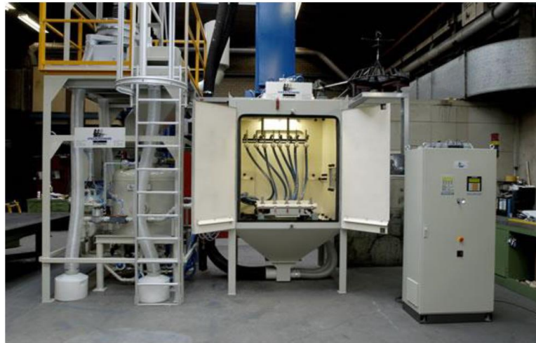
Şekil 4.9. Otomatik hava püskürtmeli bilyalı dövme cihazı.
