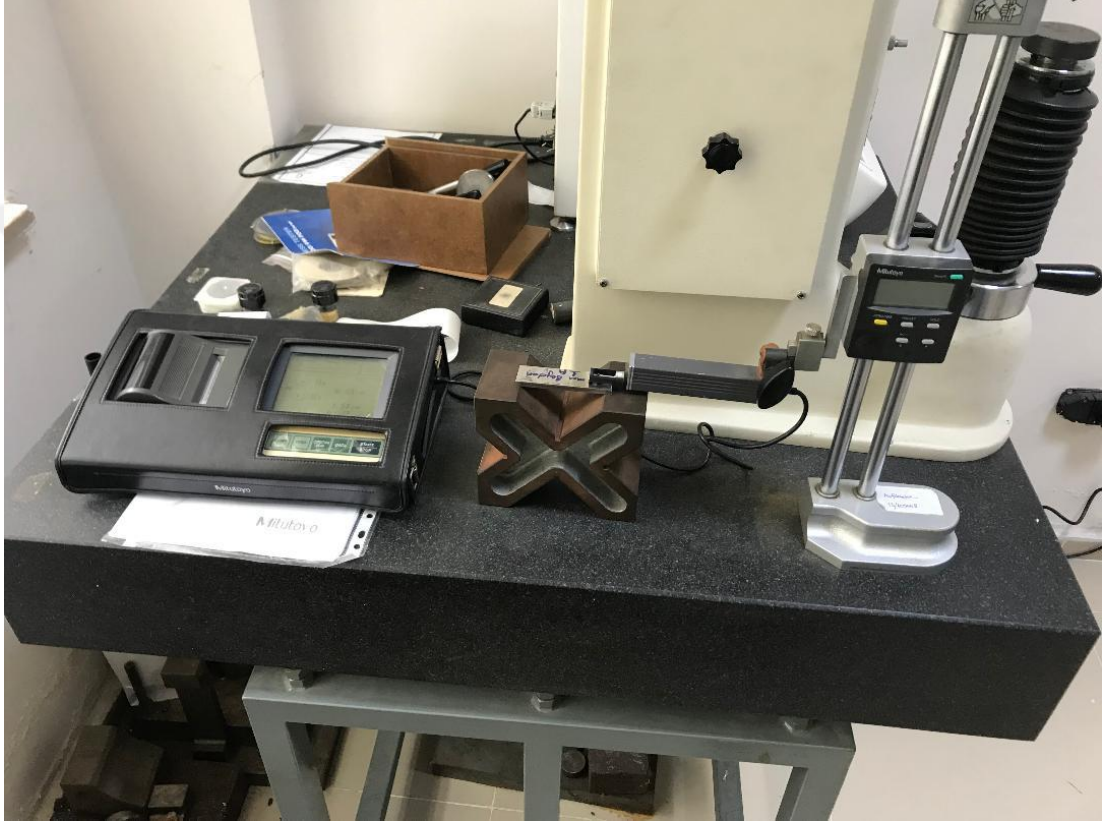
Şekil 7.20. Mitutoyo SJ-301 marka profilometre (CBÜ)
