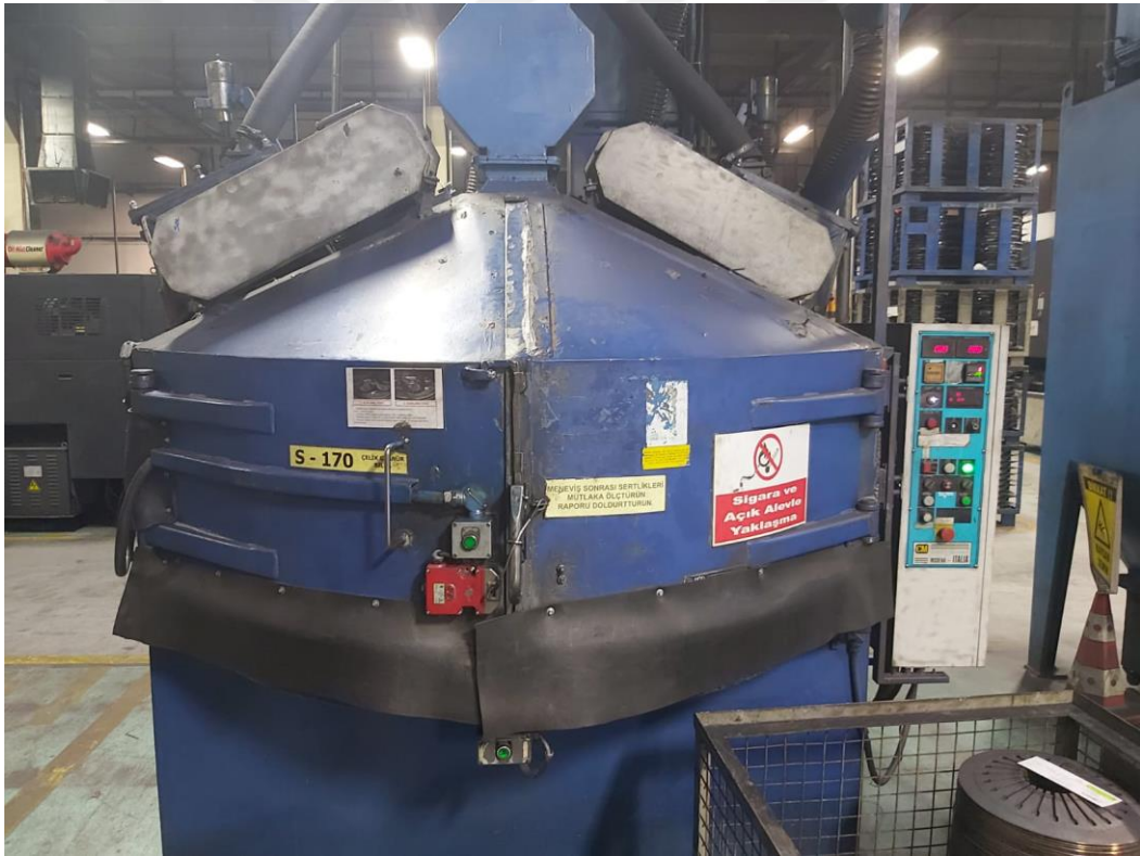
Şekil 7.11. Bilyalı Dövme Makinesi (Dönmez Debriyaj)
