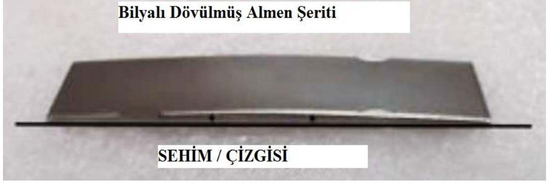
Şekil 4.2. Almen testi sonrasında şeritte meydana gelen deformasyon [37].
