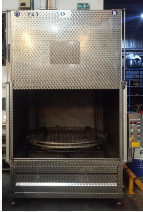
Şekil 7.3. Yıkama ve yağ alma makinesi (Dönmez Debriyaj)
