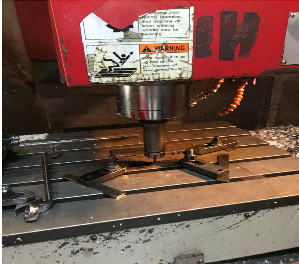
Şekil 7.9. CNC ile Yüzey kusurları oluşturma
