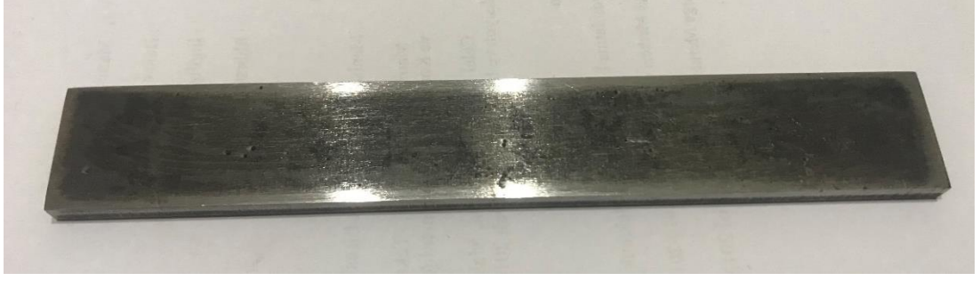
Şekil 7.12. Bilyalı dövme öncesi test numunesi
