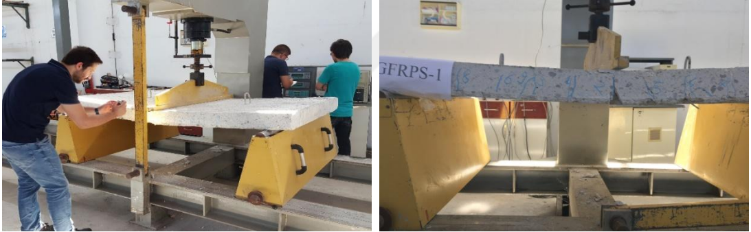
Şekil 4.7 Testler sırasında ortaya çıkan eğilme çatlakları
