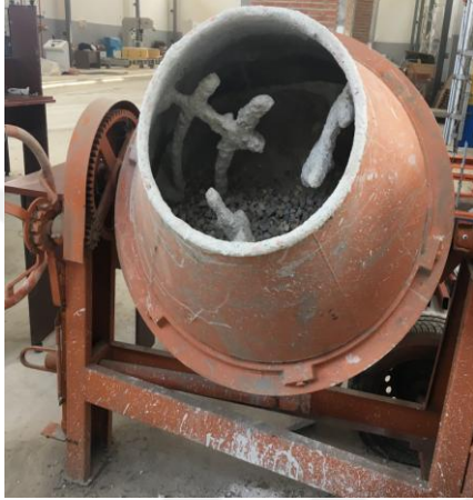
Şekil 3.6 Döşeme betonu karışımının hazırlanması
