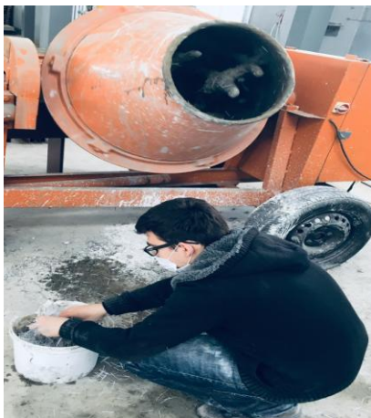
Şekil 3.7 Polipropilen lif katkısına su ilave edilip karıştırılması
