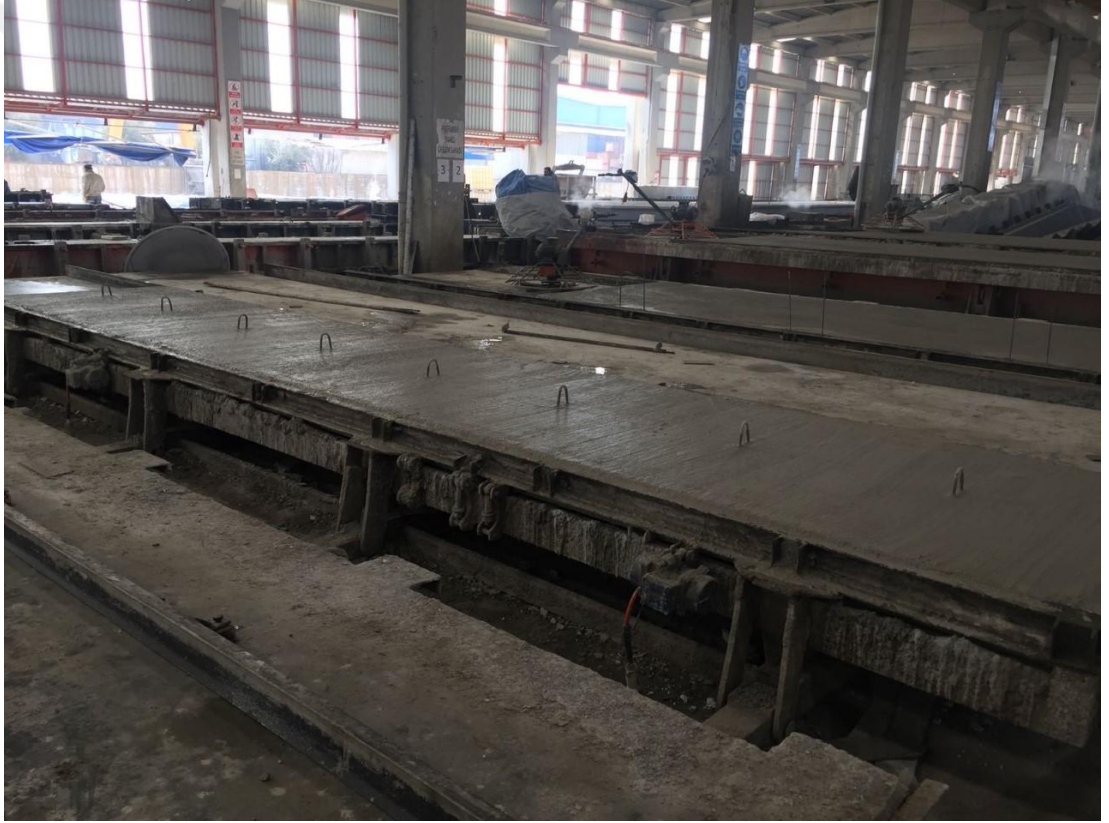
Şekil 3.1 Üretilen SS-1,SS-2, GFRPS-1 ve GFRPS-2 döşemeleri
