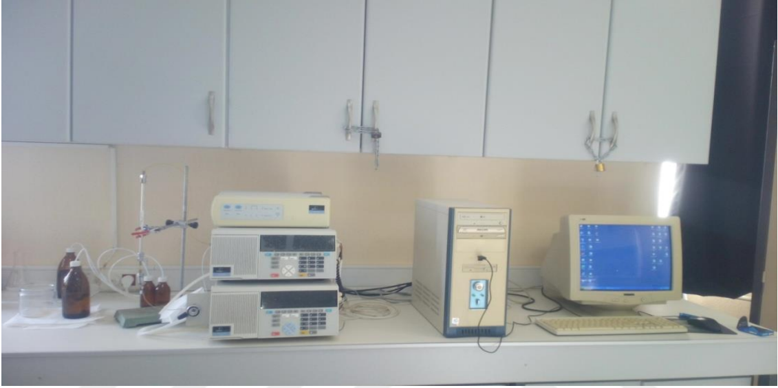
Şekil 3.1. Deneysel çalışmalarda kullanılan HPLC-UV sistemi
