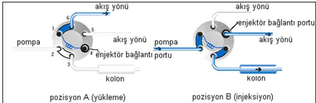
Şekil 2.2. Altı Yollu enjeksiyon valfi için yükleme ve enjeksiyon konumları
