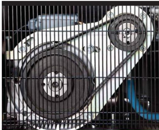
Şekil 5.1. POLY - V kasnak ve kayış
