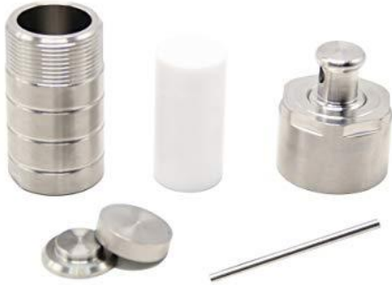
Şekil 8. Hidrotermal sentezde kullanılan teflon kaplı paslanmaz otoklav reaktörü.
