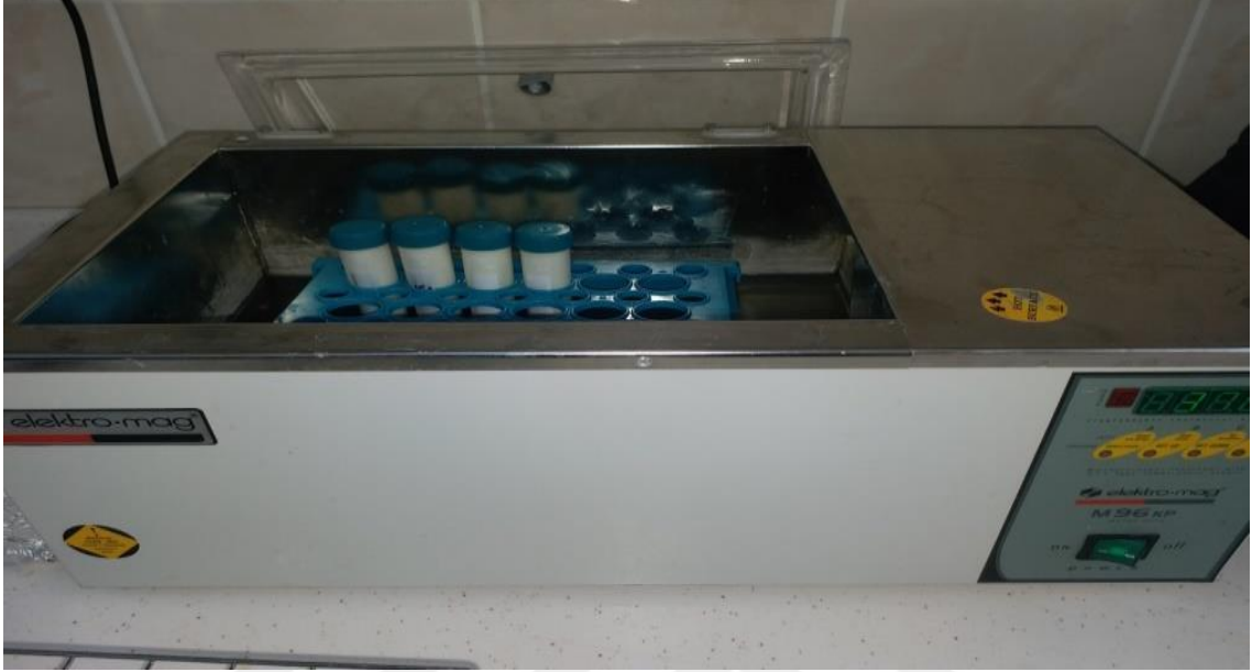
Şekil 3. Süt örneklerinin 37°C’ye ısıtılması.
