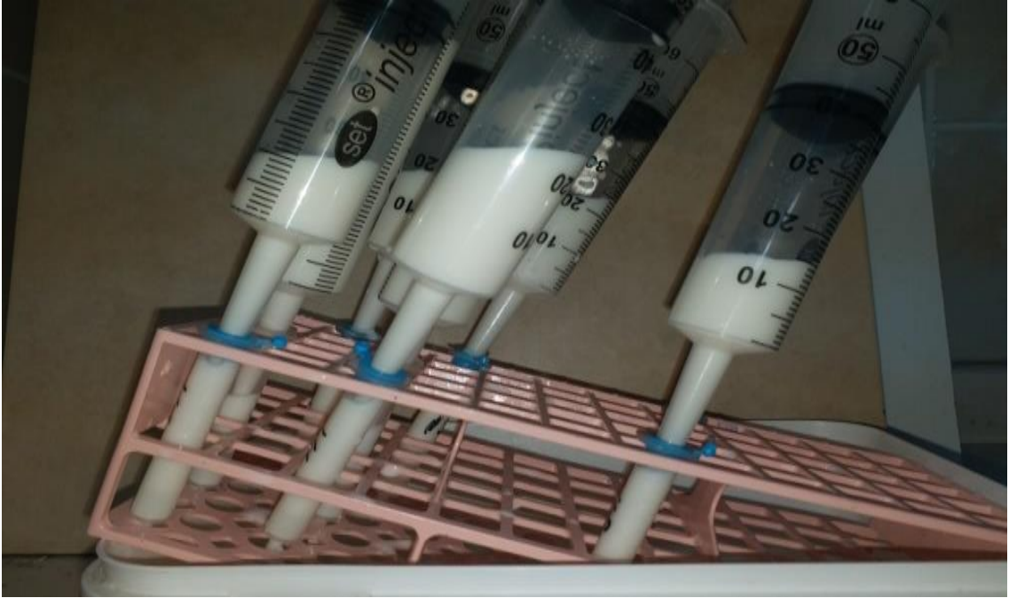
Şekil 6. IAK'dan süt örneklerinin geçirilmesi.
