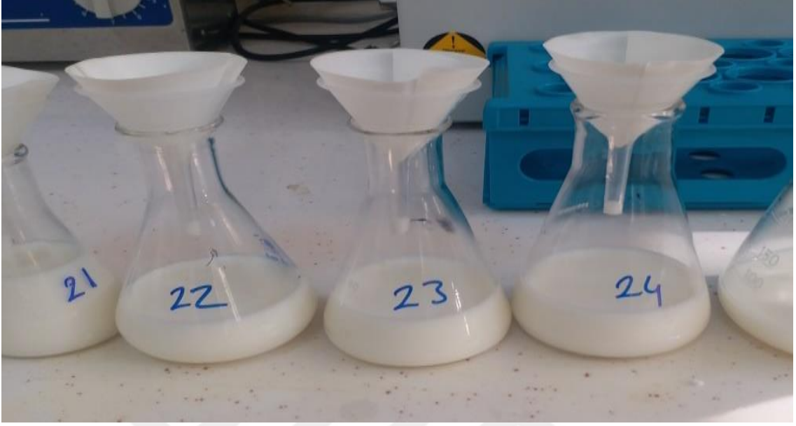
Şekil 5. Süt örneklerinin süzülmesi.
