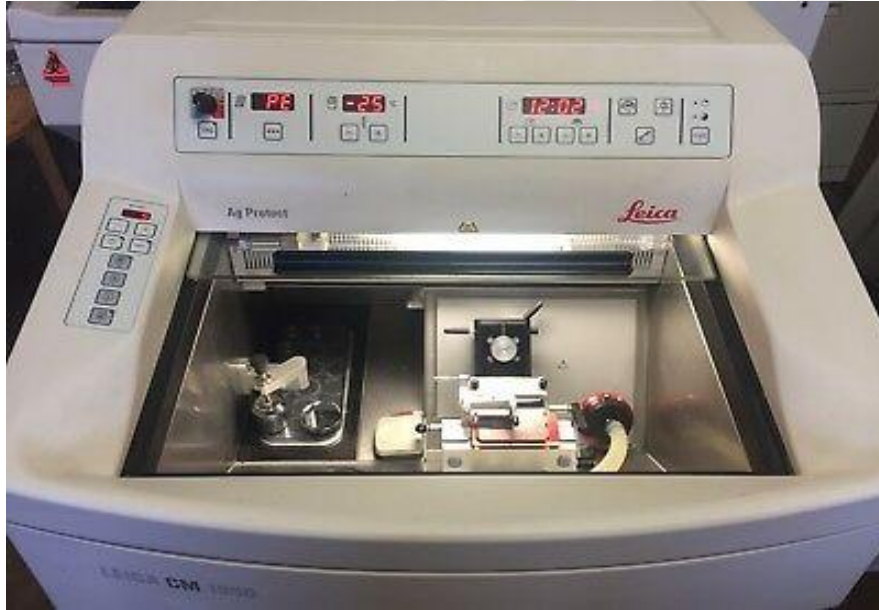
Şekil 10. Kesitlerin alındığı kriyostat cihazının işlem bölümü (Leica,Germany).
