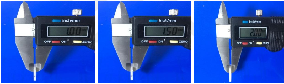
Şekil 12,13,14. Dijital Kumpas İle Örneklerin Kalınlıklarının Ölçülmesi.
