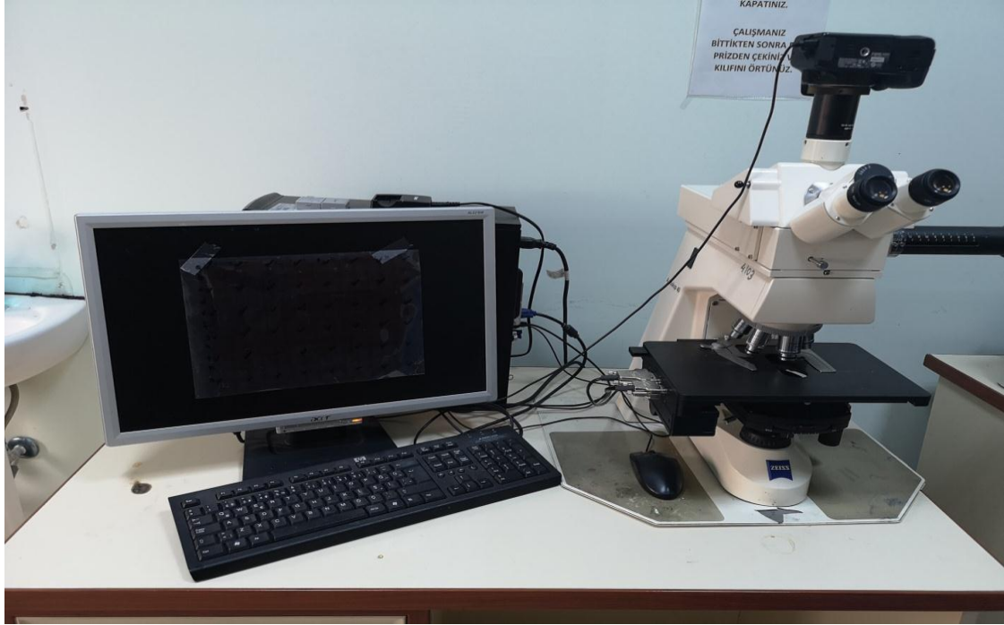
Şekil 17. Sayımda kullanılan fotoğraf ataçmanlı araştırma ışık mikroskobu (Carl Zeiss Axioskop 40 (Carl Zeiss, Göttingen, Germany)).
