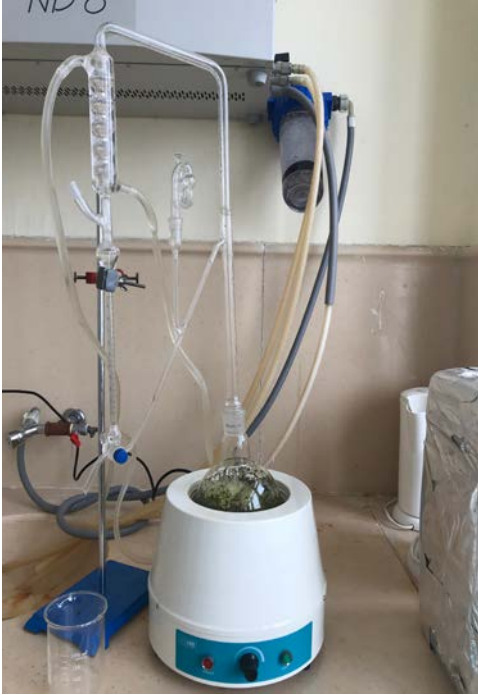
Şekil 2. Klevenger ısıtma balonunda kekik yaprağı ekstraksiyonu
