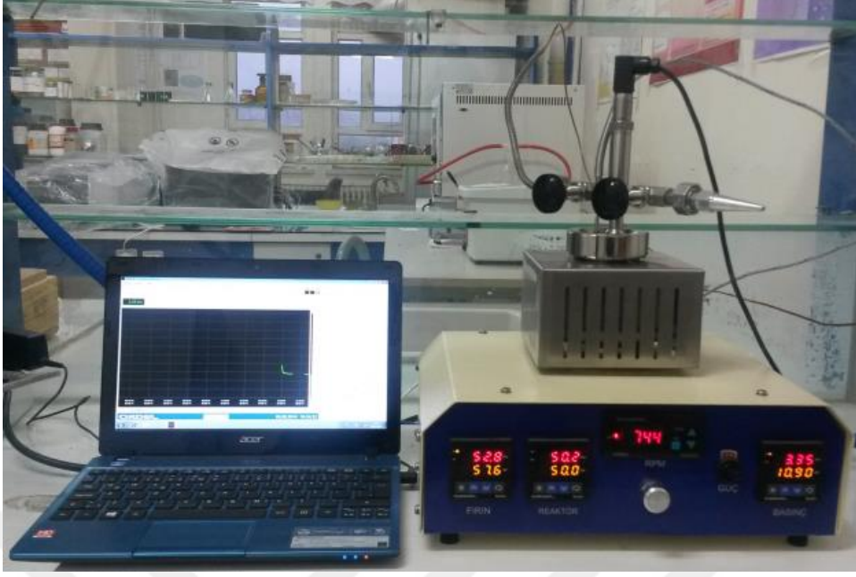
Şekil 2.1. Veratril alkolün Ru/ n -HT katalizli oksidasyonunda kullanılan laboratuvar reaktör sistemi.
