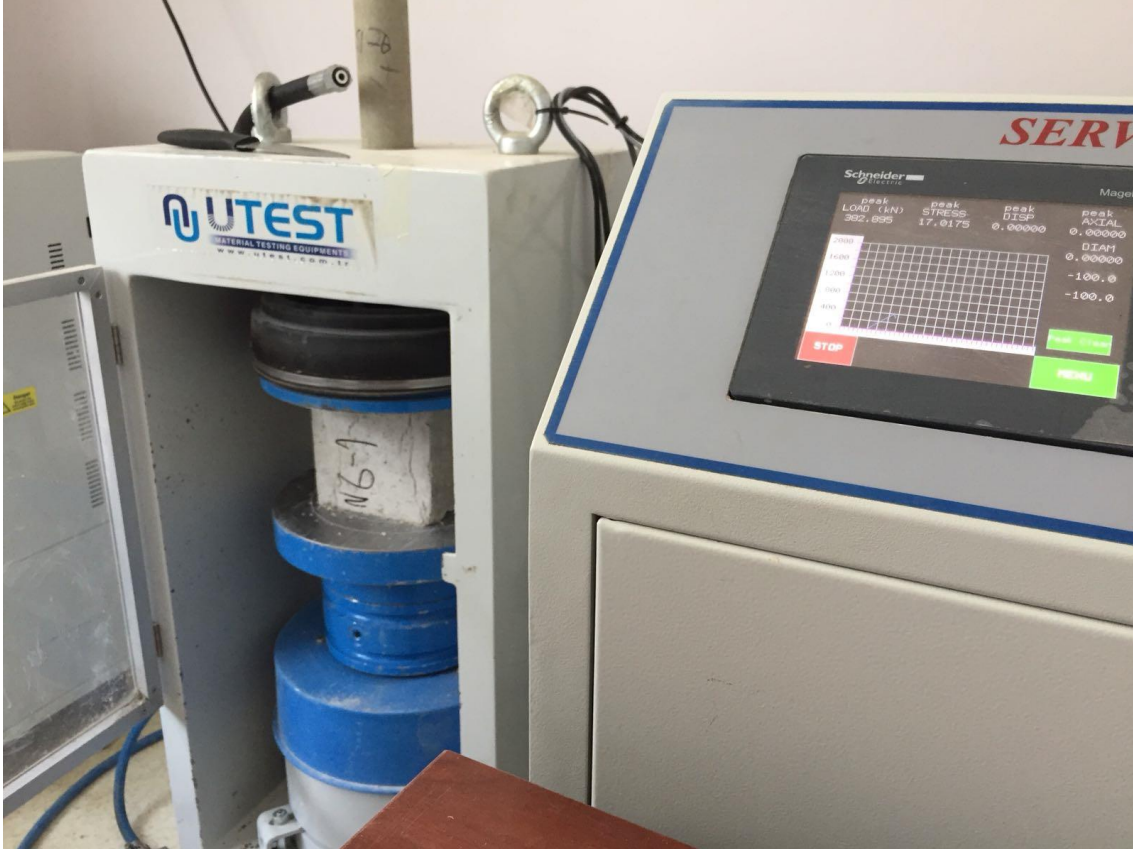
řekil 3.11. Beton basıncı dayanımı testine tabi tutulan N6-1 numaralı baę kiriři numunesi.
