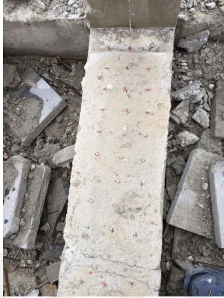
Şekil 3.12. Çivi çakılmış olan N7 numaralı bağ kirişi.
