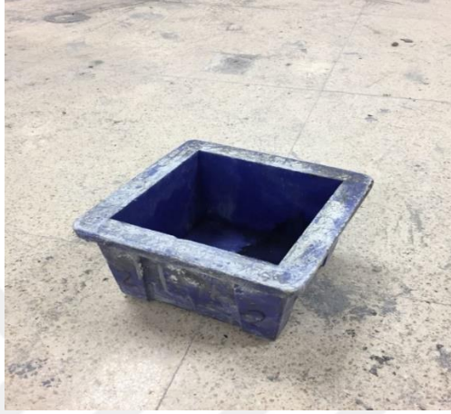
řekil 3.5. Beton kp numune kalıbı.
