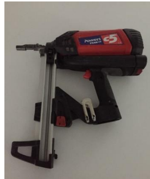
Şekil 3.2. 105 joule çivi çakma tabancası.
