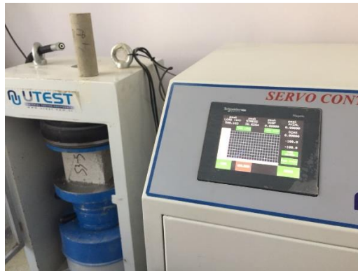
Şekil 3.13. S3 kolonuna ait 5 numaralı numunenin beton basınç dayanımı testi.
