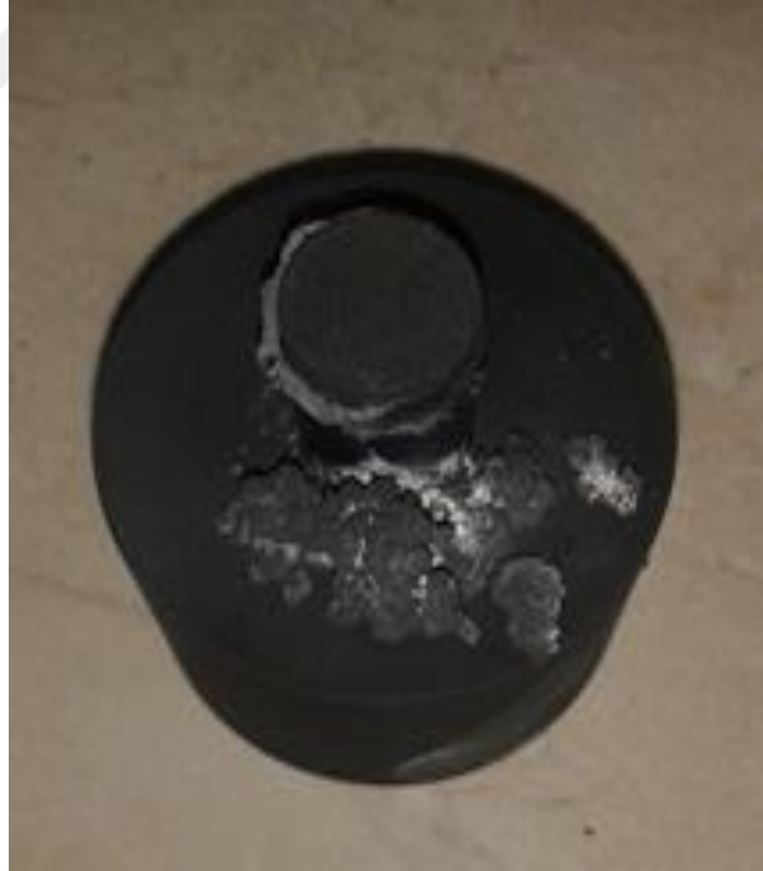
Şekil 3. 1. AZ91D alaşımının 450 °C'de 1 saat süreyle sinterleme sonrasında elde edilen görüntü.
