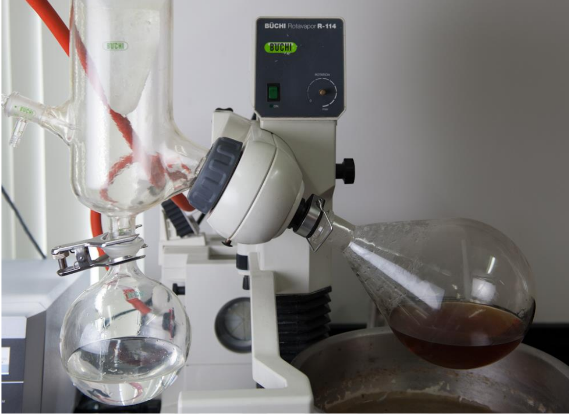
Şekil 3.2. Evaporatör ile yağ ayırma işlemi.
