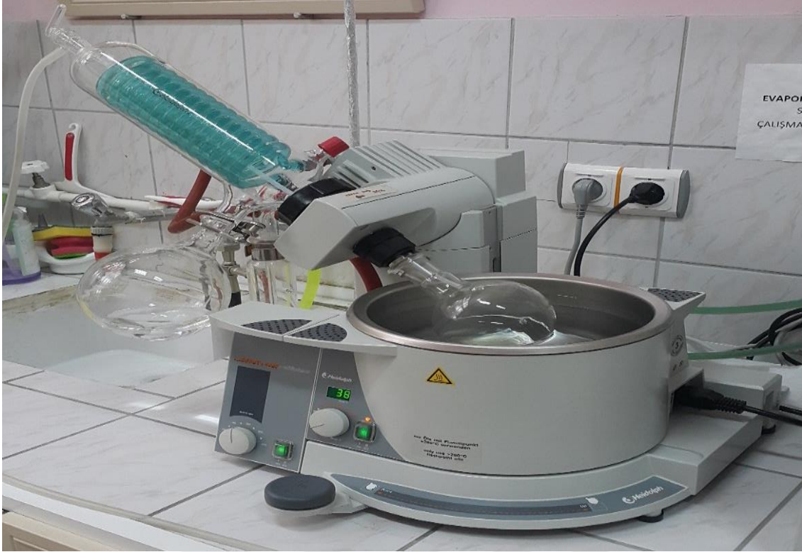
Şekil 3.4. Evaporatör ile etanolü ayırma işlemi.
