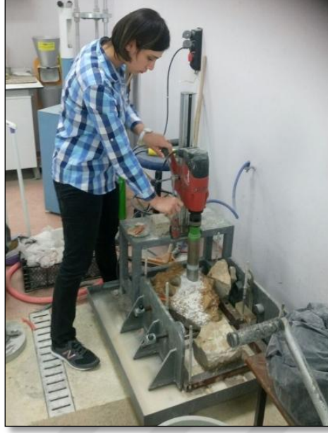
Şekil 0.2. Bent yapı malzemesi ile benzerlik gösteren çevre kayaktan alınan blok numunenin karotiyer ile kesilmesi.
