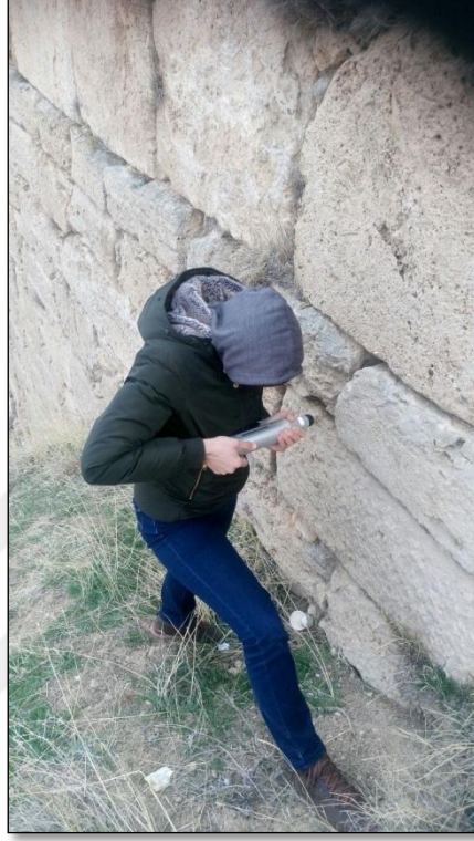
Şekil 0.1. Faruk Bendi akış yukarı duvarında Schmidt çekici deneyi.
