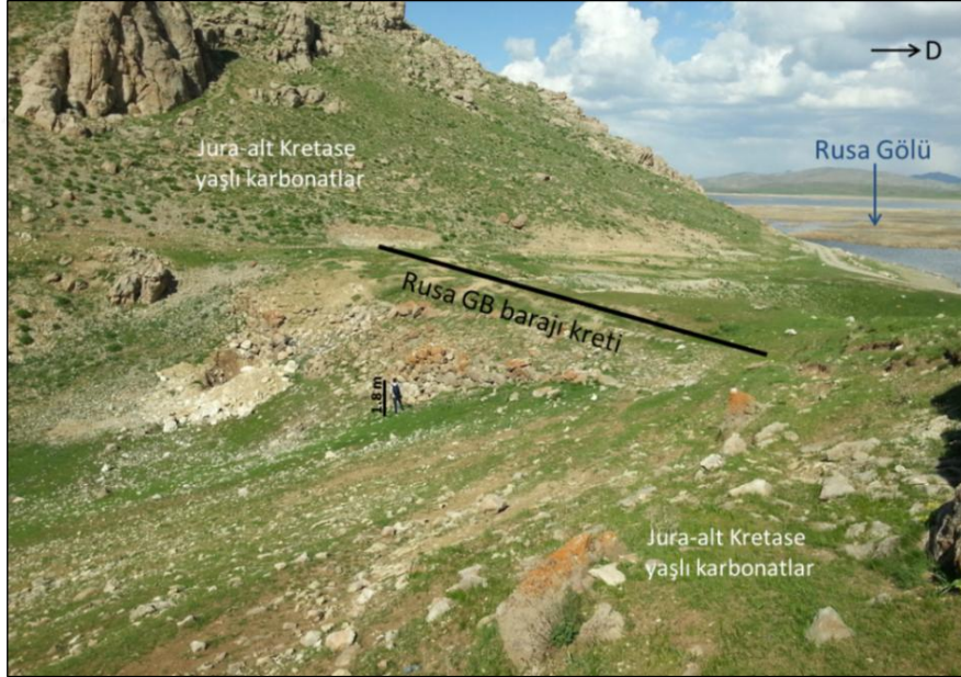
Şekil 0.10. Rusa GB barajı ve üzerinde bulunduğu jeolojik birimler.
