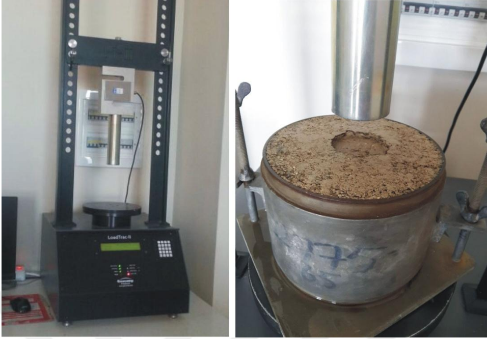
Şekil 3.10. Kaliforniya taşıma oranının laboratuvarında belirlenmesi a) kullanılan CBR deney düzeneği ve b) zemin numunesine uygulanişı.
