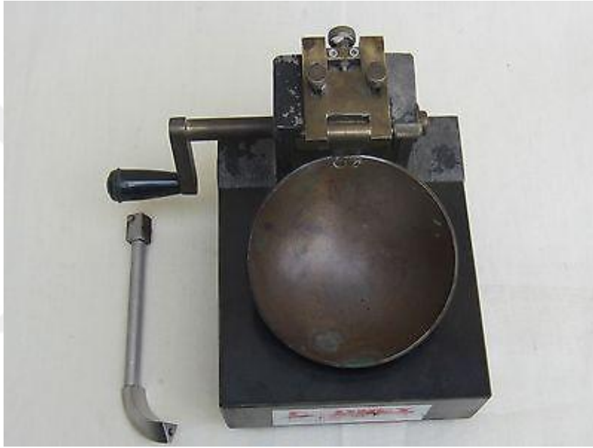
Şekil 3.5. Casagrande likit limit cihazı ve oluk açma bıçağı.
