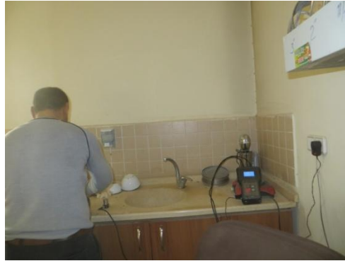
Şekil 4.7. Hazırlanan numuneler üzerinde UPV ölçümleri.
