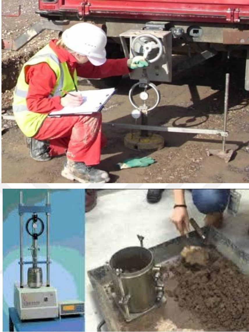
Şekil 3.9. Kaliforniya taşıma oranının arazide ve laboratuvarında belirlenmesi.
