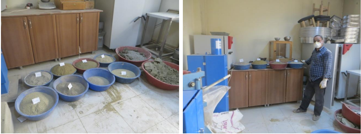
Şekil 4.1. Laboratuvar ortamına getirilen zemin örneklerinin hazırlanması.
