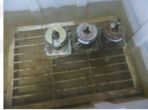
Şekil 4.6. Kaliforniya taşıma oranı deneyleri öncesi örneklerin ıslatma süreci.
