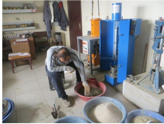
Şekil 4.3. Zemin örnekleri üzerinde yapılan standart proktor testleri.
