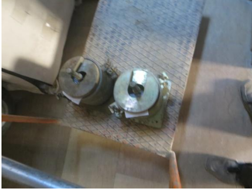
Şekil 4.6. Kaliforniya taşıma oranı deneyleri öncesi örneklerin ıslatma süreci.
