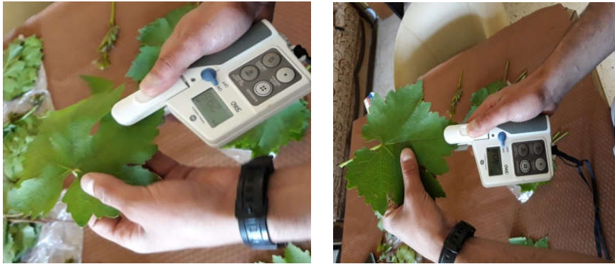
Şekil 3.39. Spad yöntemiyle yaprakların okunması.
