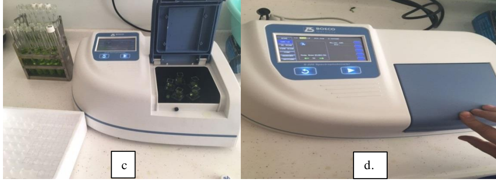
Şekil 3.13. Klorofil analizi a. dondurulmuş örneklerin tartılarak etil alkol ile karıştırılması, b. örneklerin su banyosunda bekletilmesi, c. örneklerin cihaza yerleştirilmesi, d. sonuçların okunması (devamı) .
