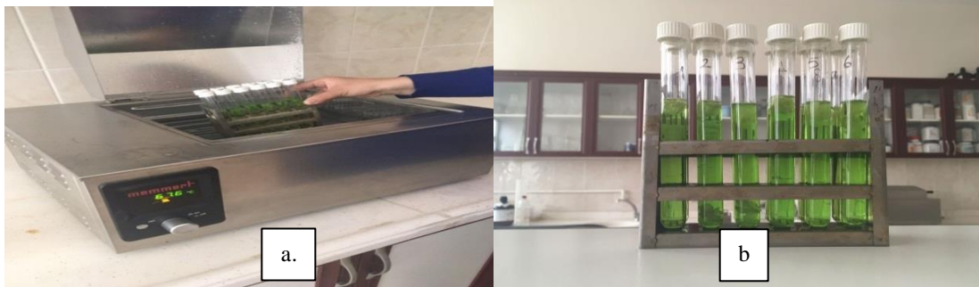
Şekil 3.13. Klorofil analizi a. dondurulmuş örneklerin tartılarak etil alkol ile karıştırılması, b. örneklerin su banyosunda bekletilmesi, c. örneklerin cihaza yerleştirilmesi, d. sonuçların okunması.
