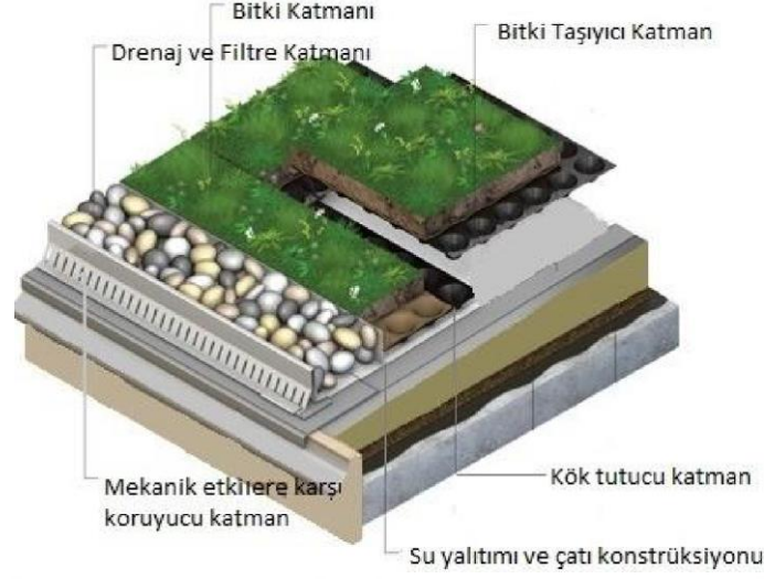
Şekil 2. Ekstensif sistem katmanları.
