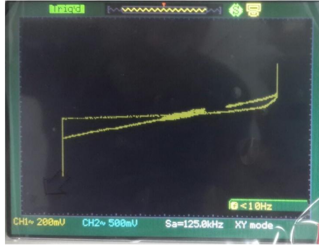
Şekil 4.34. 9 Hz sinüsoidal gerilimle beslenen memristör taklitçisinin histeresiz eğrisi.
