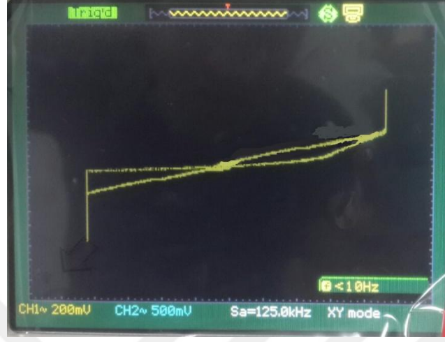
Şekil 4.33. 8 Hz sinüsoidal gerilimle beslenen memristör taklitçisinin histeresiz eğrisi.
