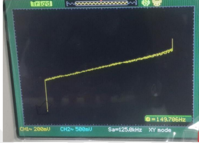
Şekil 4.35. 150 Hz sinüsoidal gerilimle beslenen memristör taklitçisinin histeresiz eğrisi.
