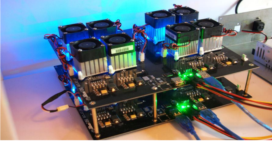
Şekil 3.3. İki adet FPGA kullanılarak oluşturulan sistem (Kılıçkır, 2014).
