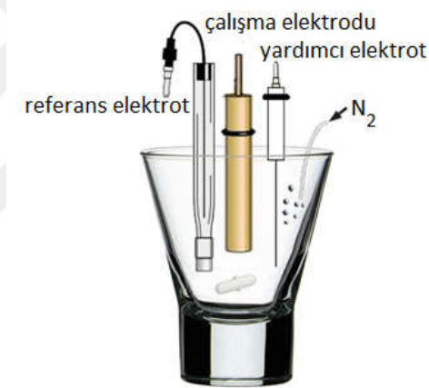
Şekil 2.9. Elektrokimyasal hücre ve bileşenleri (Özkan ve ark., 2015'ten uyarlama).
