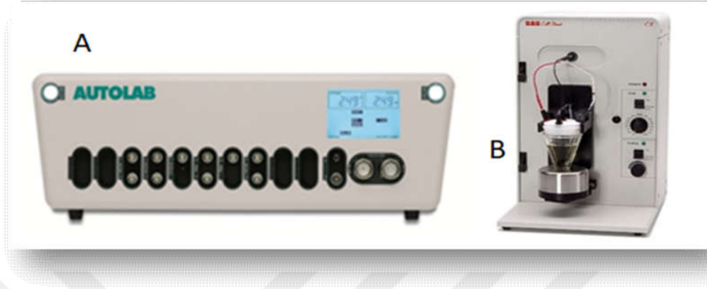
Şekil 3.1. Autolab PGSTAT 128N elektrokimyasal analizör (A) ve BAS C3 katı elektrot hücre standı ünitesi (B).
