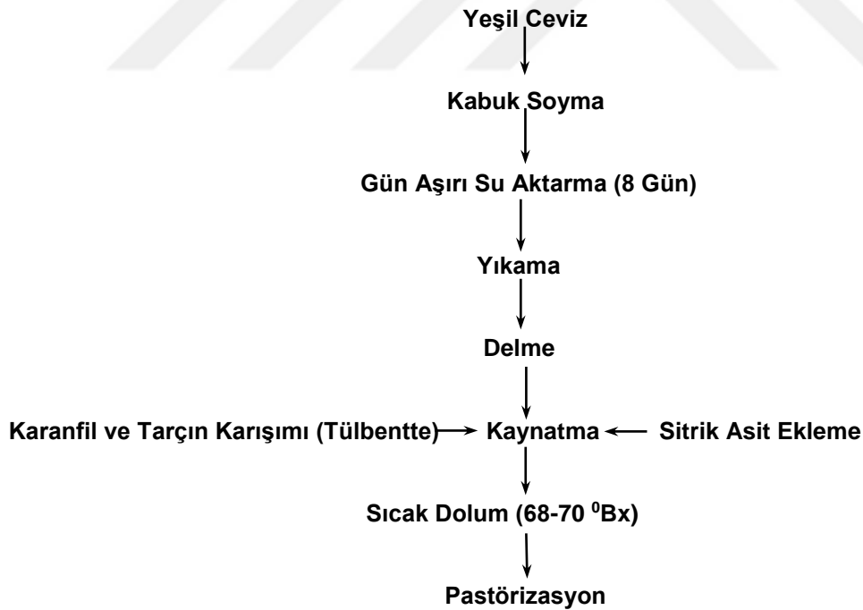
Şekil 1.1. Örnek ceviz şekeri üretim akış şeması (Bakkalbaşı ve Artık, 2005).
