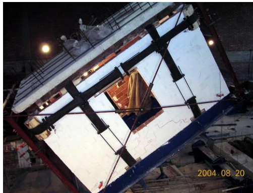
Şekil 2.7. Güçlendirilmiş yığma bina deneyi (Türer ve ark., 2013).
