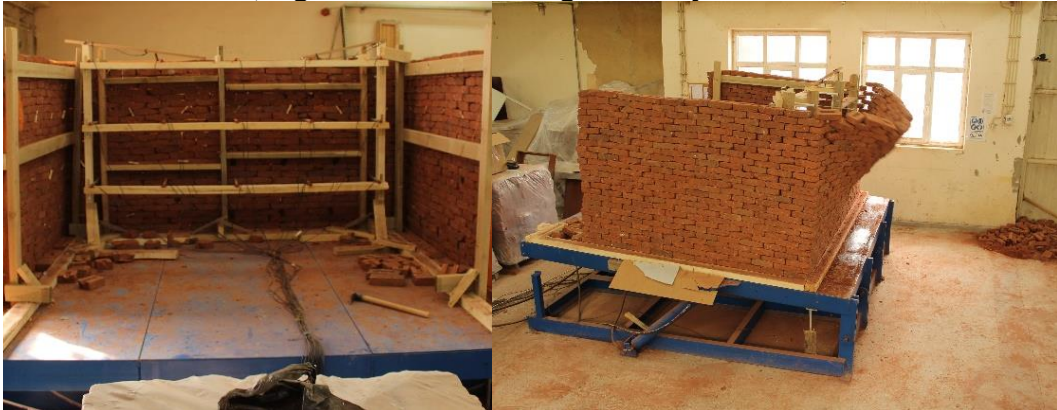
b) Deney elemanı ve deplasman ölçerlerin konumları.
