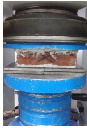
b) Yüzeyi düzleştirilmemiş numune basınç testi
