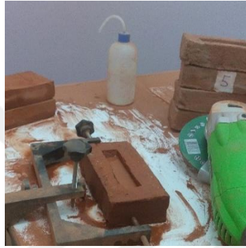
a) 5 adet numunenin yüzey düzleştirilmesi
