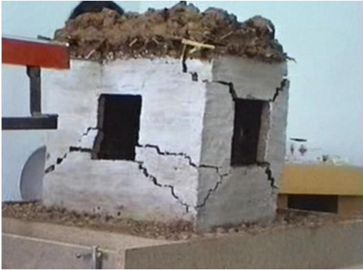
a) Yığma bina testi (Korkmaz, 2007).
