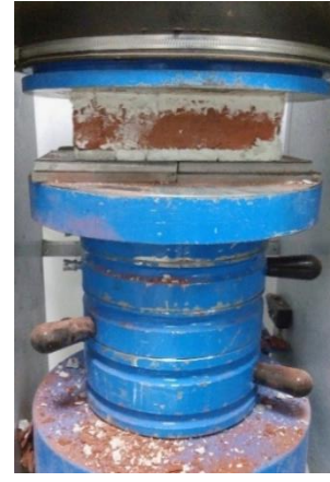
c) Yüzeyi düzleştirilmiş numune basınç testi
