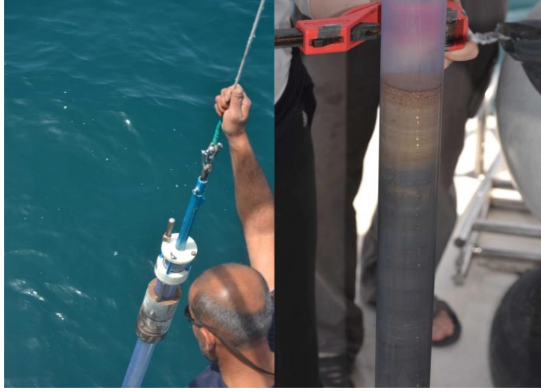
Şekil 2.1. Gravite karotlayıcı ile sediman karot alımı.
