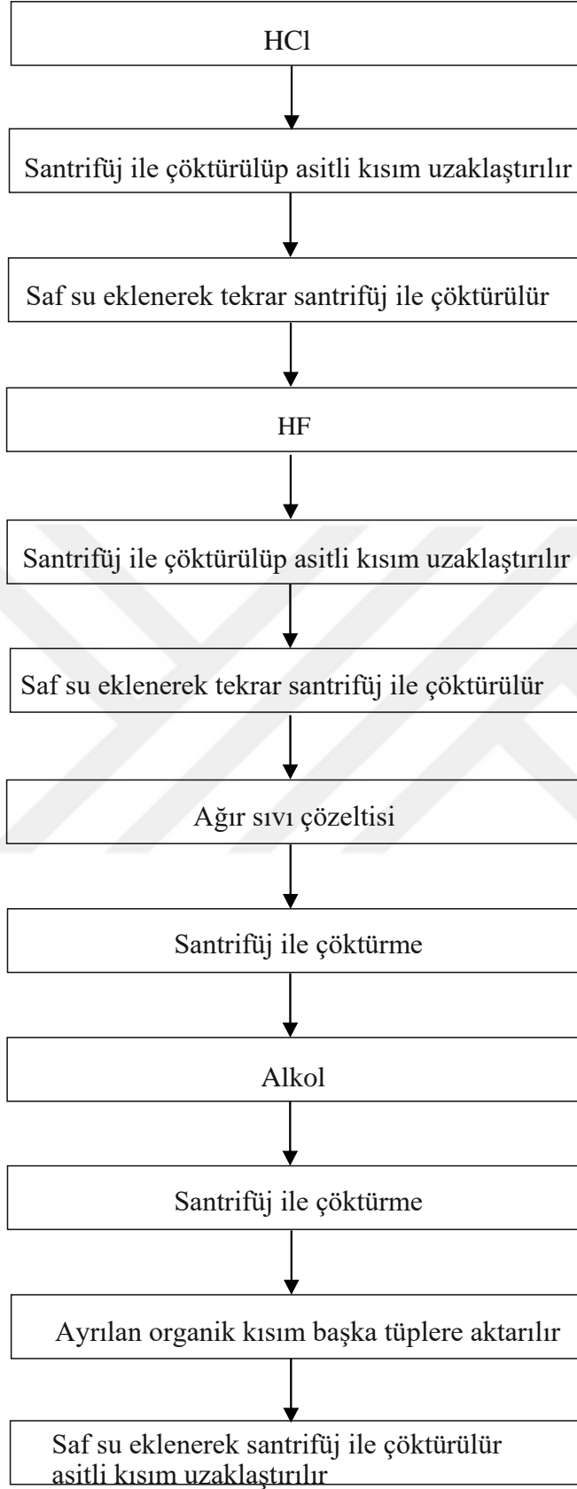
Şekil 3.2. Palinolojik örnek hazırlama aşamaları.
