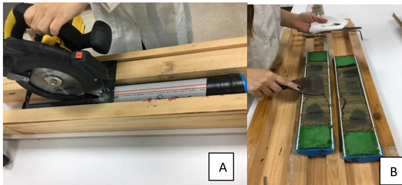
Şekil 3.1. Karot örneklerinin A) daire testere kullanılarak kesilmesi B) Spatula ile örnek yüzeylerinin düzeltilmesi.
