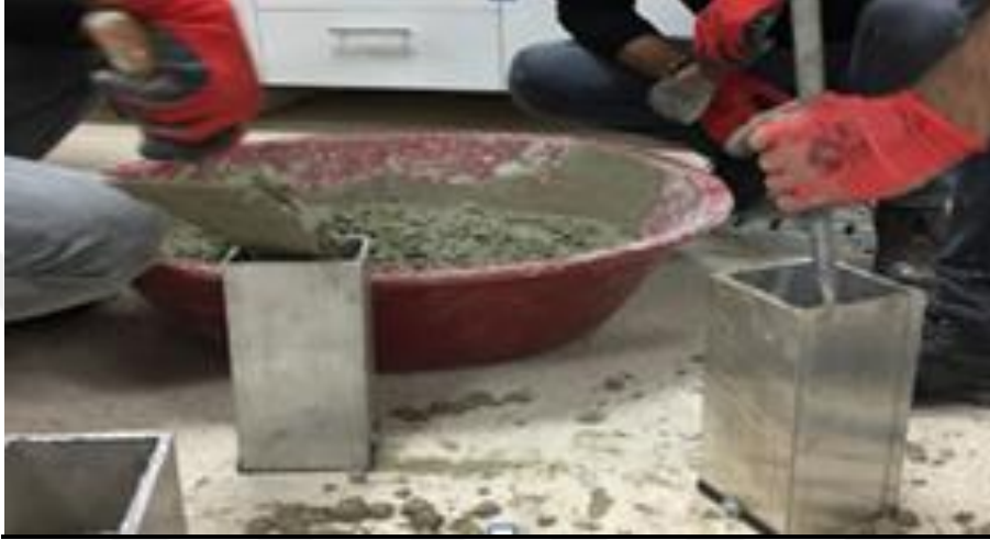
Şekil 3.4. Beton karışımının alüminyum tüplere yerleştirilmesi.
