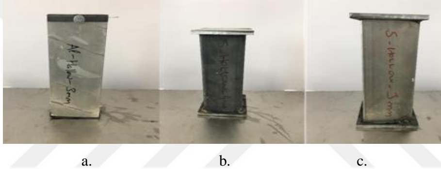
Şekil 3. 1. Boş kolon numunelerin deney öncesi görünüşleri a. AL, b.CS, c. SS.
