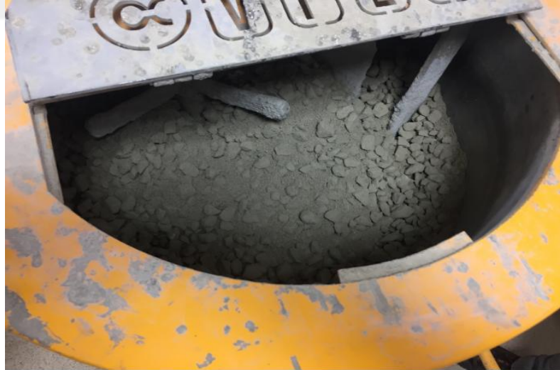
Şekil 3.3. Pan mikserde hazırlanan beton karışımı görünümü.
