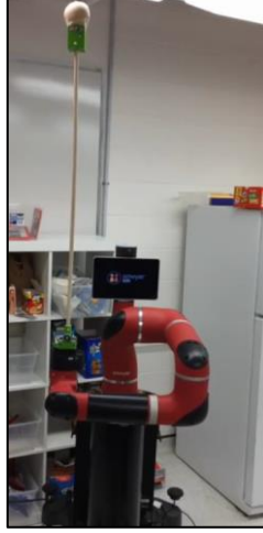
Şekil 2.3. Robotik kol ile dengelenen ters sarkaç sistemi.
