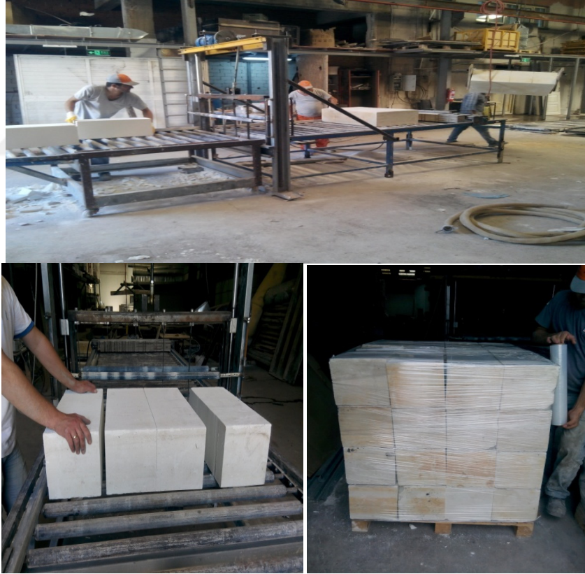
Şekil 4.2. Köpük beton kesim makinesi(üstte), köpük betonun kesimi(sağ alt), köpük betonun ambalajlanması(sol alt).
