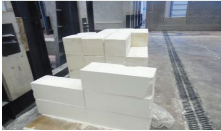
Şekil 3.24. Ses yalıtım testi için üretilen proje kapsamında geliştirilen çimento bağlayıcılı izolasyon malzemesi.
