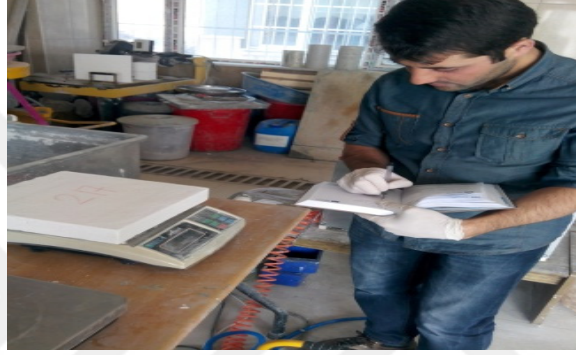
Şekil 3.23. Isı iletim için yapılmış numune yoğunluk değerinin belirlenmesi.
