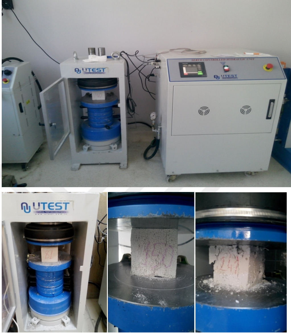
Şekil 3.18. Üretilen köpük betonların basınç mukavemet testi.
