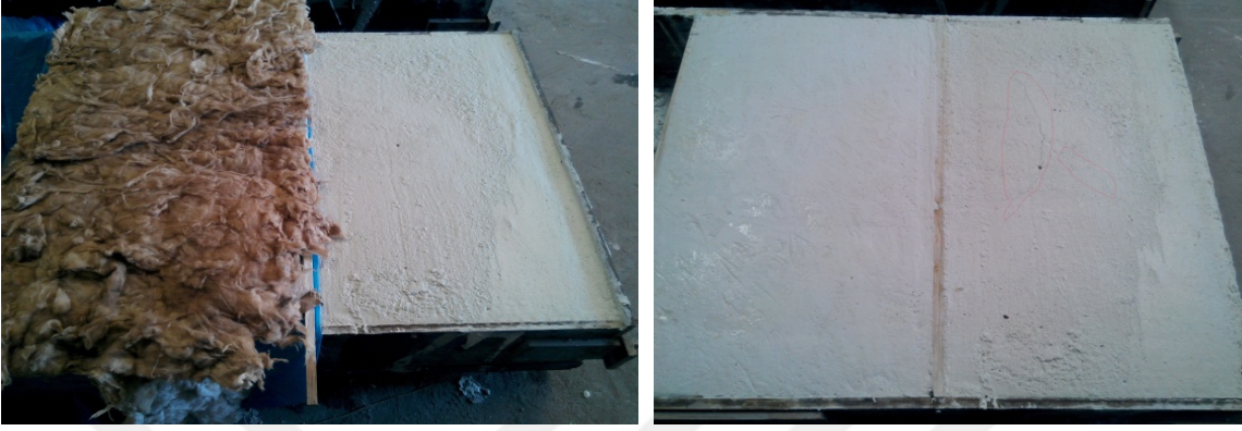
Şekil 4.1. Kür yapılmış numune ile kür işlemi yapılmamış numune görüntüsü.
