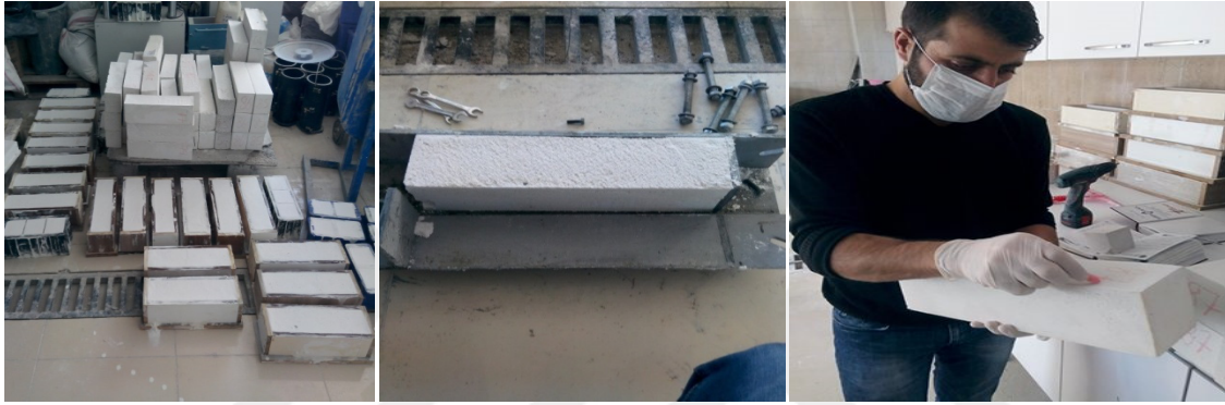
Şekil 3.11. Çekme dayanım deneyi için hazırlanan numune görüntüleri.
