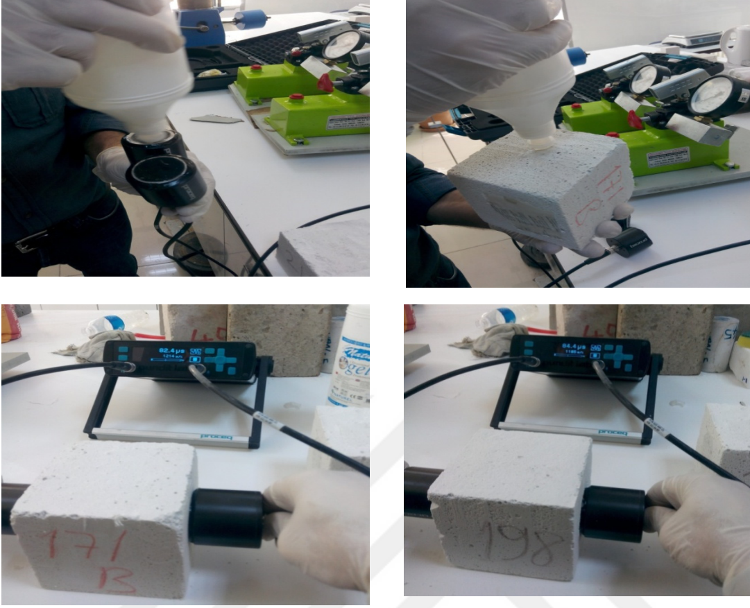
Şekil 4.10. Üretilen köpüklü beton numunelerin ultrases geçirgenliği testi.
