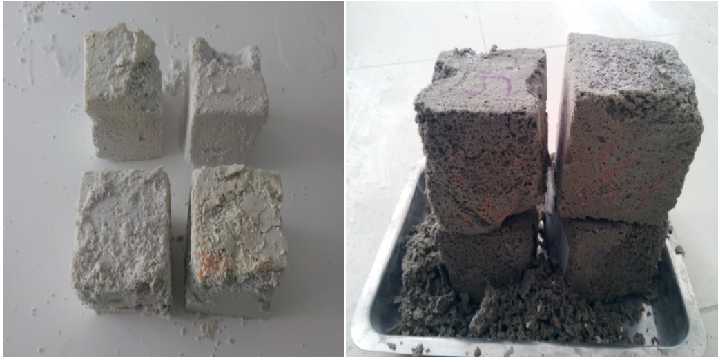
Şekil 4.14. Deneyde başarısız olan numunelerin görünüşleri.
