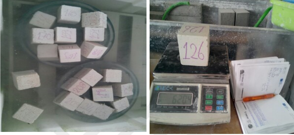
Şekil 4.15. Suya doymun numunelerin birim ağırlıklarının hesaplanması.
