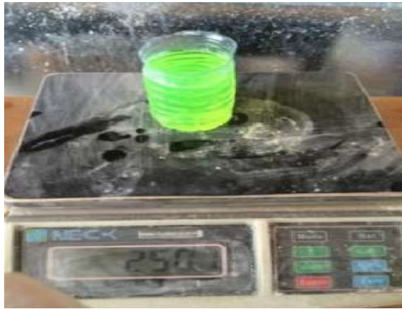
Şekil 3.3. Laboratuarda ürettiğimiz sentetik lateks katkıli köpük ajanı.
