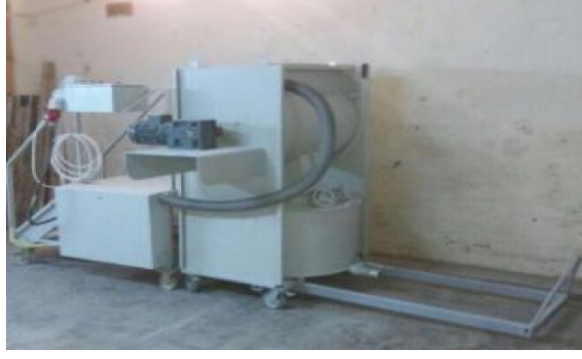
Şekil 3.7. Köpük jeneratörü, pompası ve mikseri.
