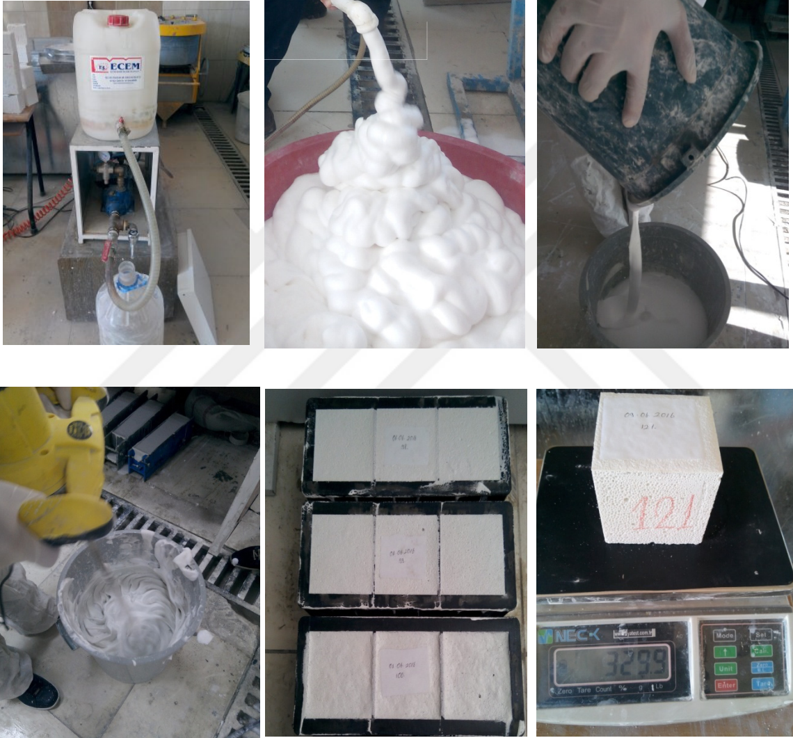
Şekil 3.15. Köpük betonunun laboratuarda döküm aşamaları.
