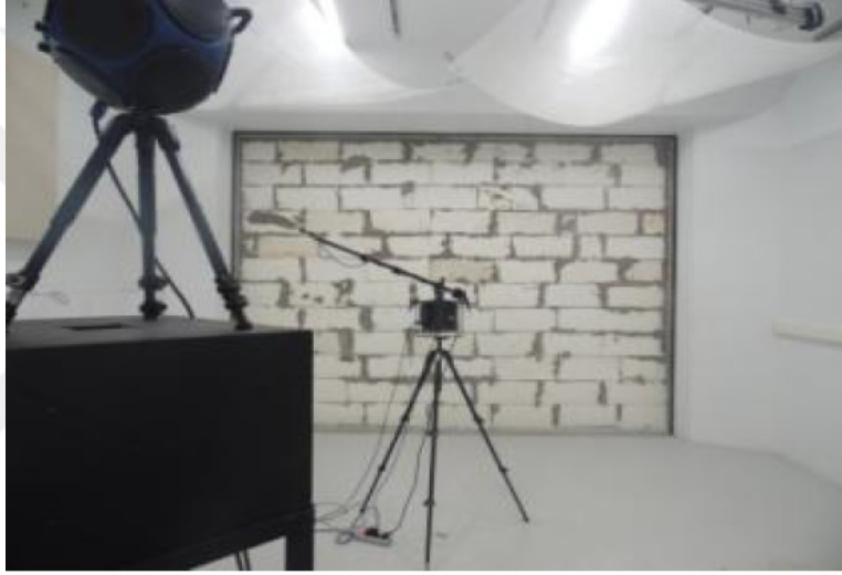
Şekil 3.26. Ses yalıtım testi.
