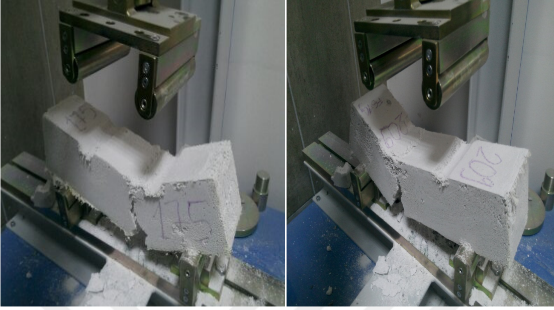
Şekil 4.8. Lif içerkli numune çekme dayanım deneyi.
