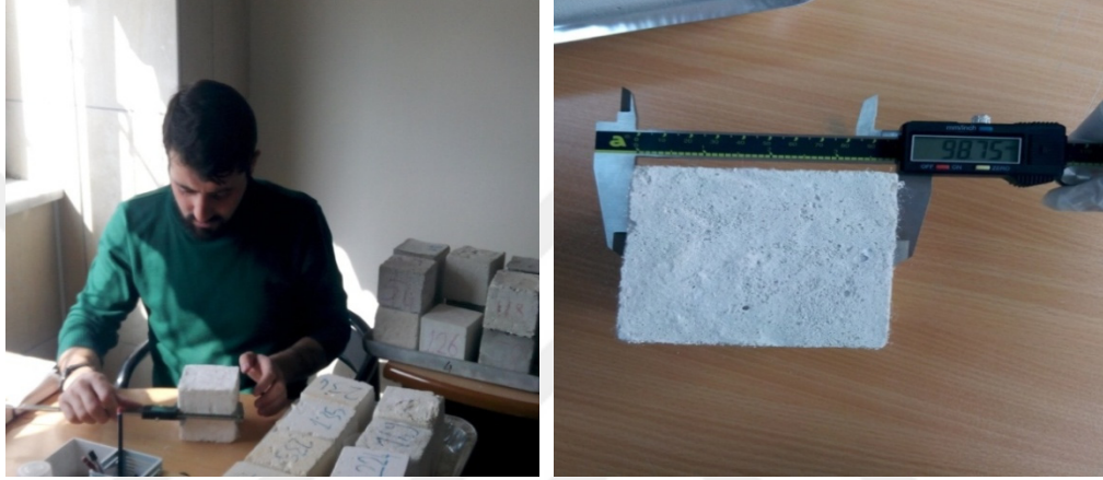
Şekil 3.17. Kumpas ile numune boyutlarının ölçülmesi.
