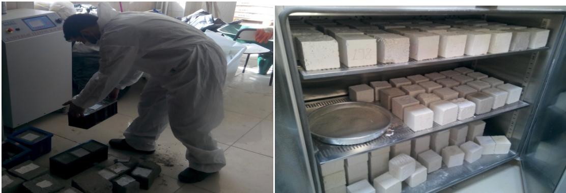
Şekil 3.10. Basınç numunelerinin üretimi (solda), basınç numunelerinin etüv görüntüleri (sağda).
