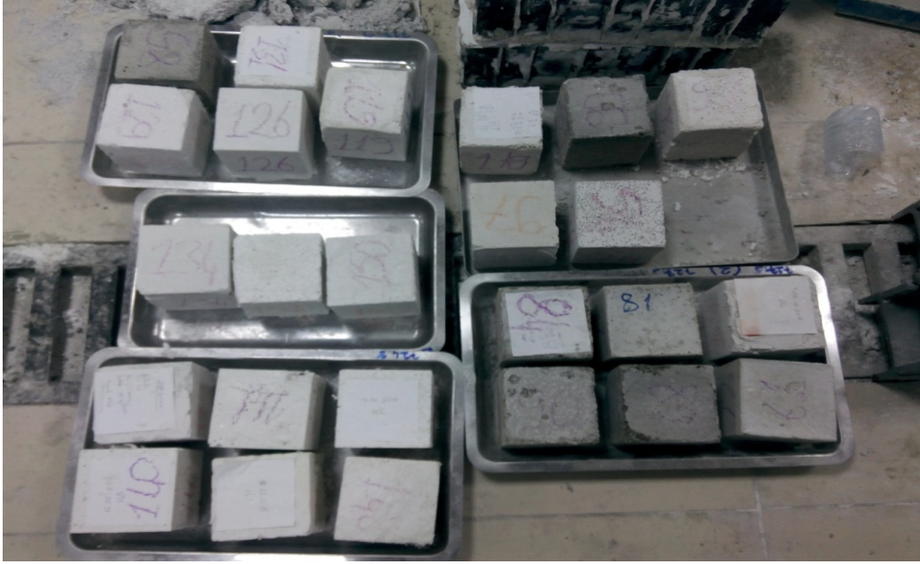
Şekil 4.13. Donma-çözülme döngüsü sonucunda başarılı olan numuneler.
