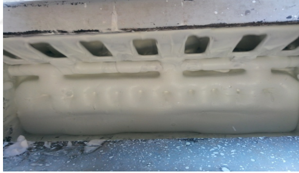
Şekil 3.9. Köpük betonun mikserde karıştırılması.
