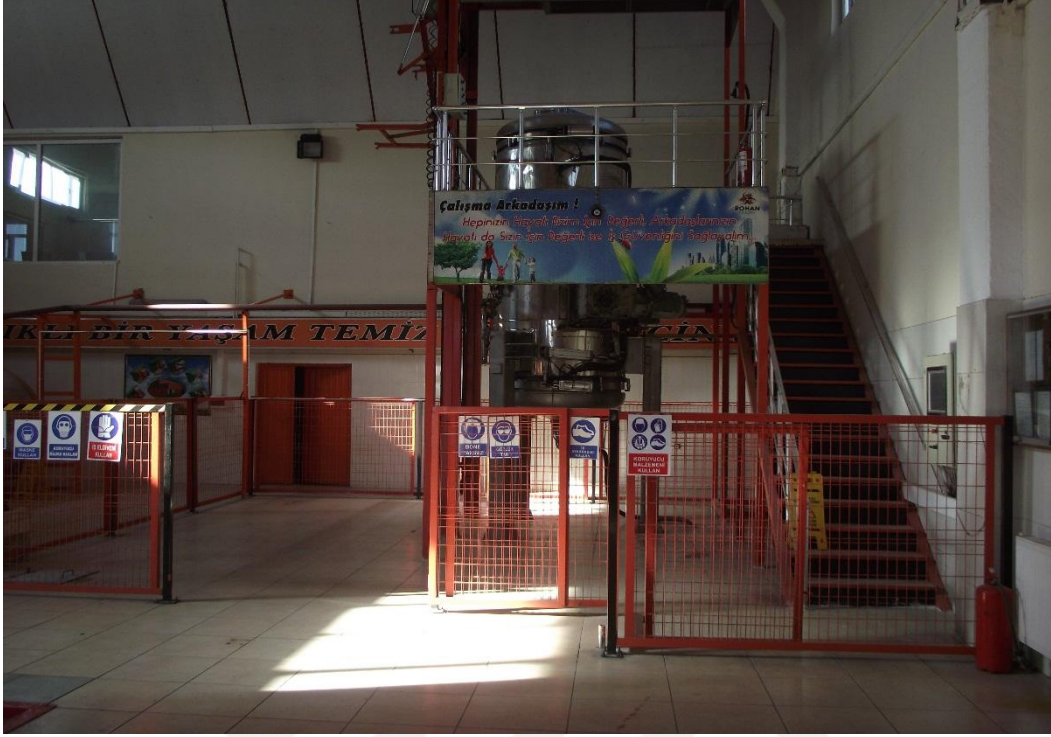
Şekil 3.3. Sterilizasyon cihazı (Van tıbbi atık sterilizasyon tesisi, 2018).
