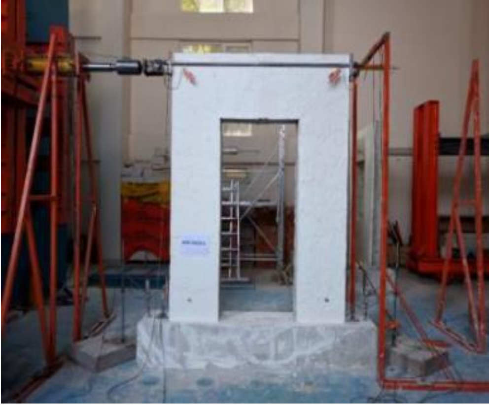
Şekil 3.36. Hidrolik piston, yük hücresi ve başlık plakaları.
