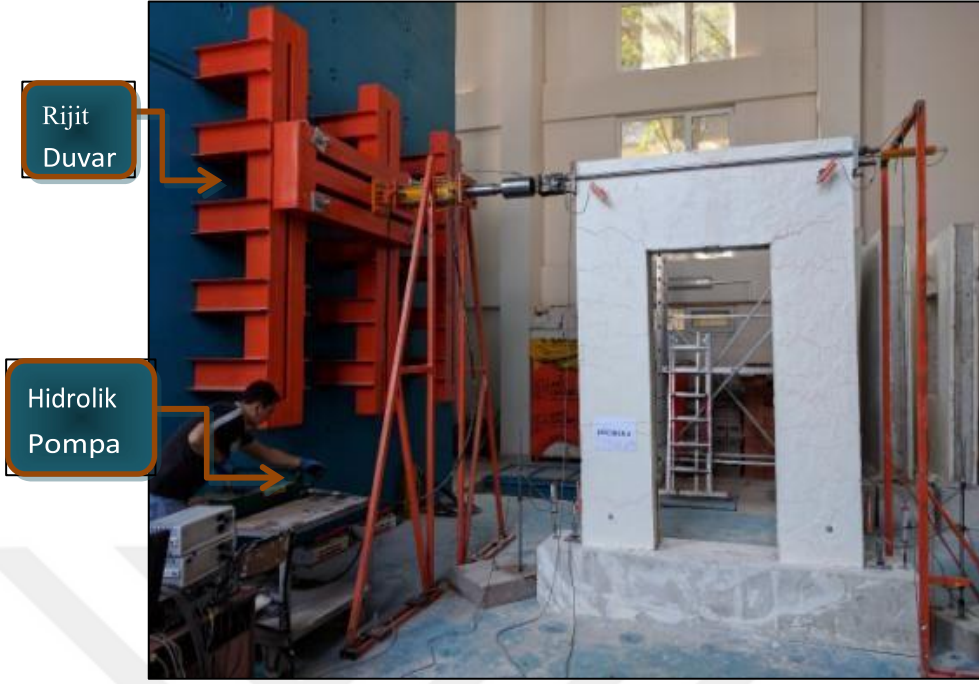
Şekil 3.35. Hidrolik piston, yük hücresi ve başlık plakaları.
