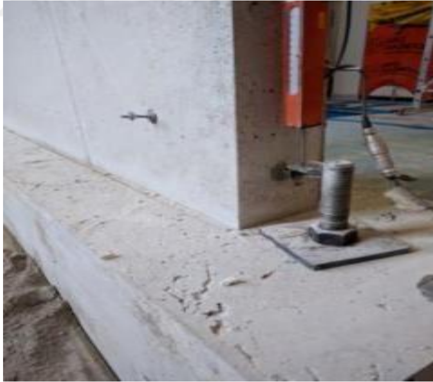
Şekil 3.32. Betonarme elemanın rijit temelinden gijonlarla sabitlenmesi.
