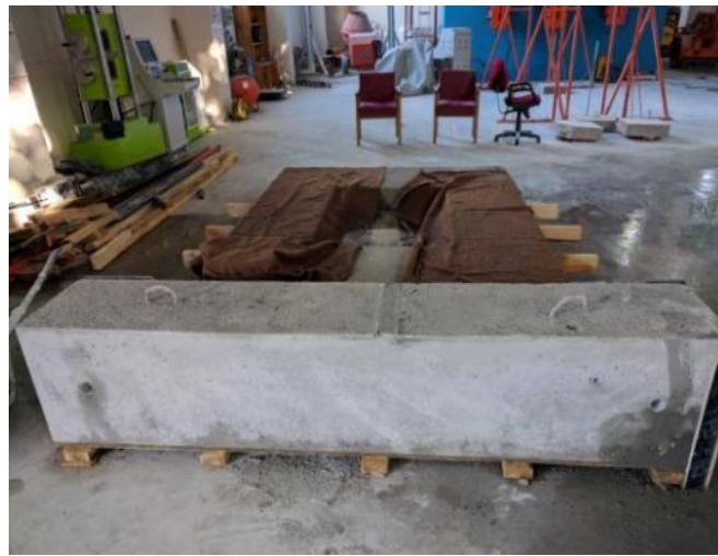
Şekil 3.25. Betonarme Elemanlara Kür Yapılması.
