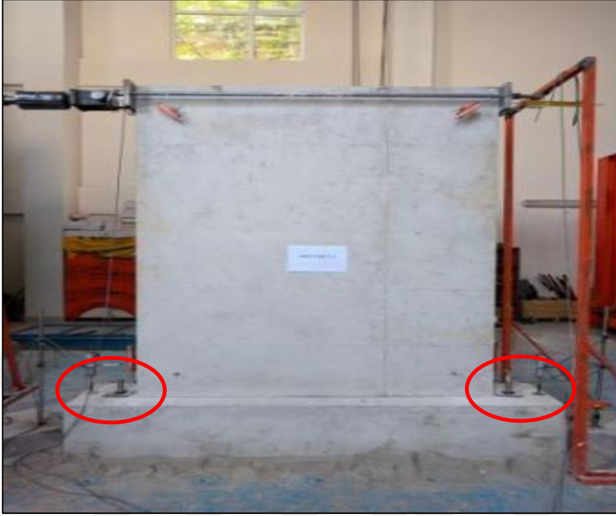
Şekil 3.33. Betonarme elemanın sağdan ve soldan gijonlarla sabitlenmesi.
