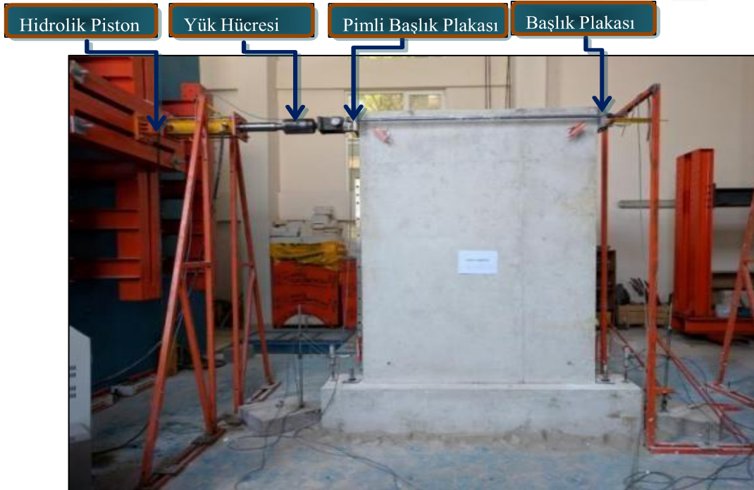
Şekil 3.34. Rijit duvar, hidrolik piston, yük hücresi ve başlık plakaları.
