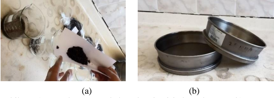
Şekil 3.6 a) AMF'lu toprağın beher glass içerisinde toplanması. b) 80 ve 45 µm'luk elekler .
