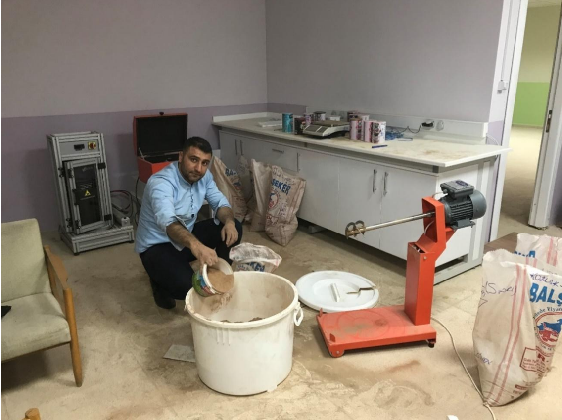
Şekil 4.1. XRD ve kimyasal analizler için hammadde örneklerinin bünye karışımlarının laboratuvar ortamında hazırlanması.
