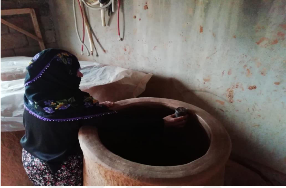
Şekil 7 Erzincan Bölgesi Tandır Yapımı: Tandırın Perdahlanma(lögün) aşaması (Bekir Özgür Arşivi)
