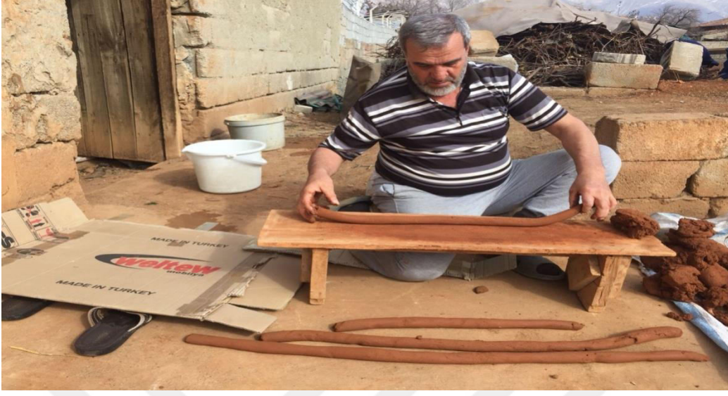
Şekil 5 Erzincan bölgesi tanır yapımı: Tandır bantlarının hazırlanması (Bekir Özgür Arşivi)
