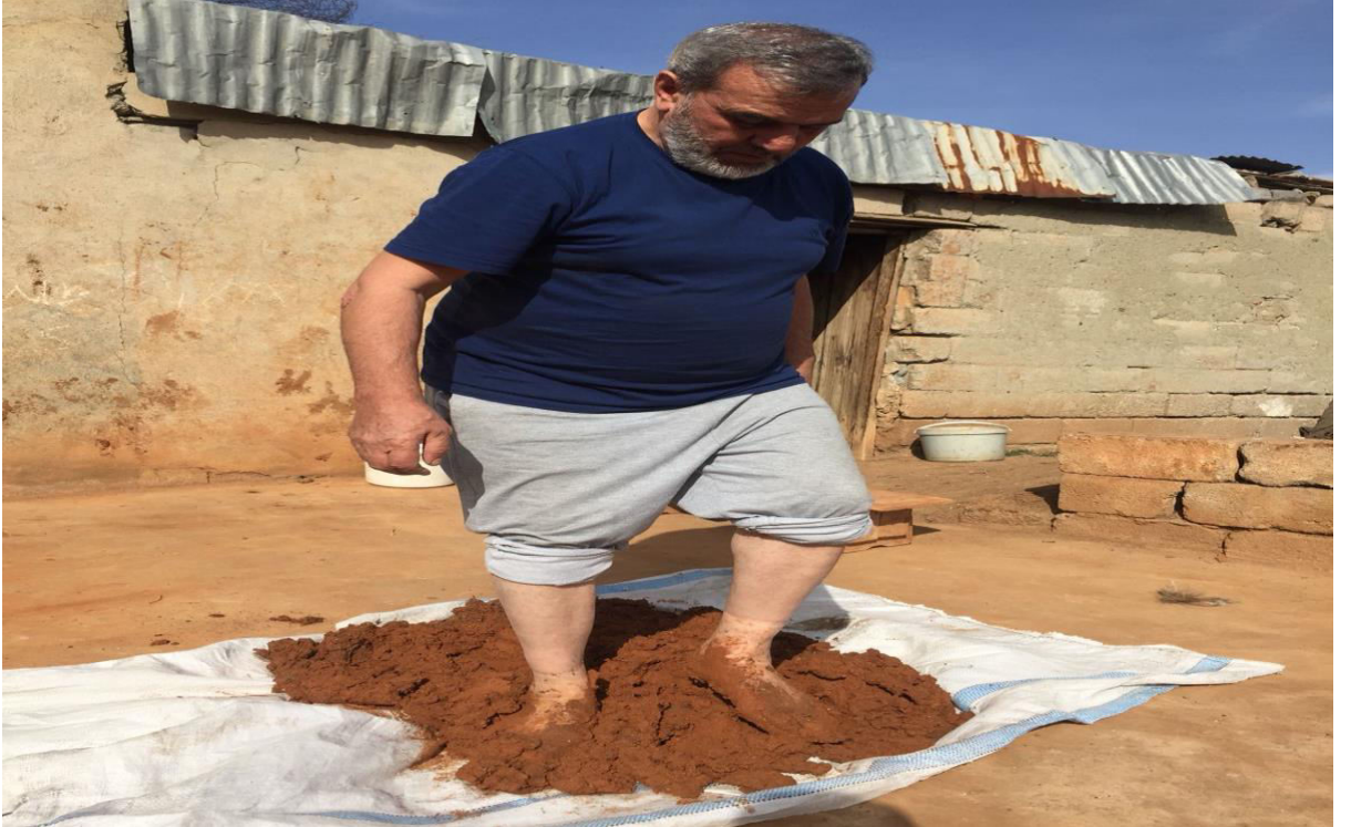
Şekil 4Erzincan bölgesi tandır yapımı kil toprağın çamur hale getirilmesi (Bekir Özgür Arşivi)
