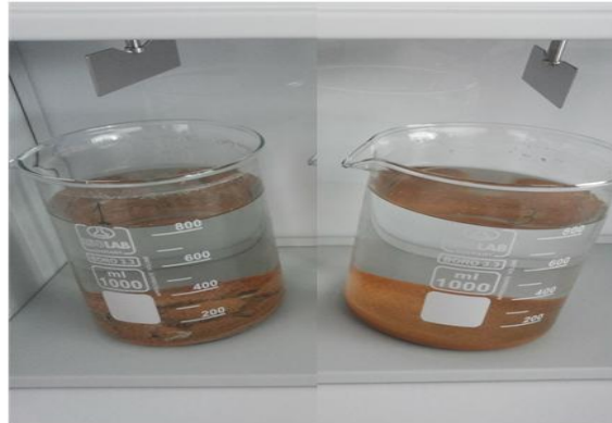
Şekil 4.6. pH 4-10, karıştırma hızı 100 rpm ve koagülant dozu 500 mg/L olan arıtılmış atıksular.
