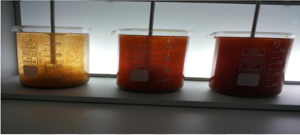
Şekil 3.3. Koagülant ilavesi yapılmış yavaş karıştırma esnasındaki atıksular.
