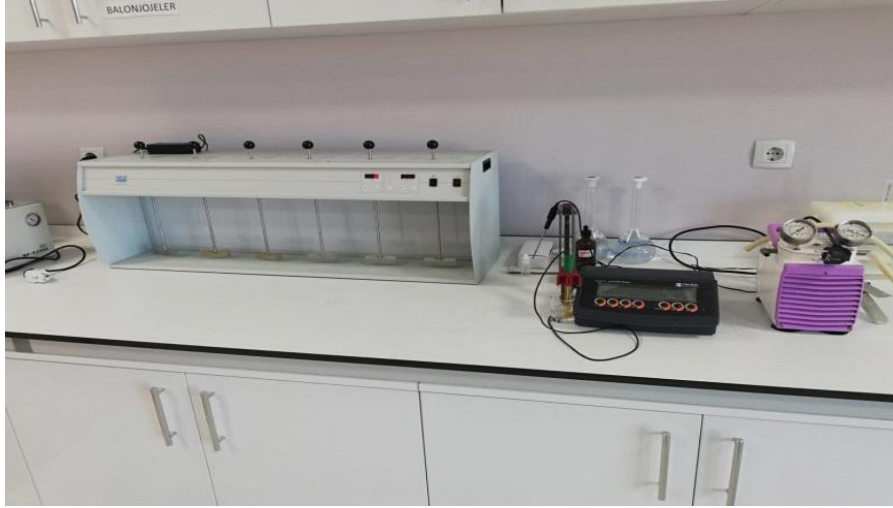
Şekil 3.1. Boya endüstrisi atıksuyunun arıtımında kullanılan deney seti.
