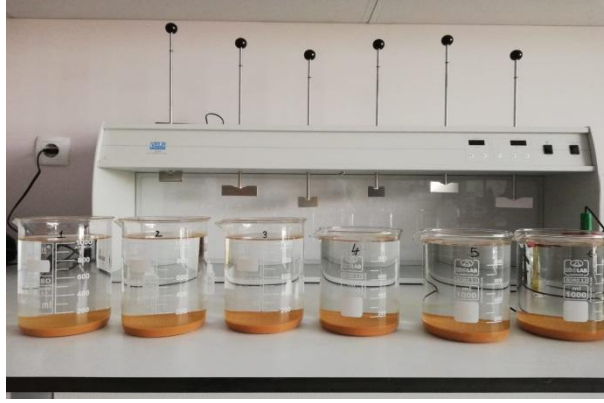
Şekil 4.1. pH 7, karıştırma hızı 150 rpm, koagülant dozu 1000 mg/L olan arıtılmış atıksular.
